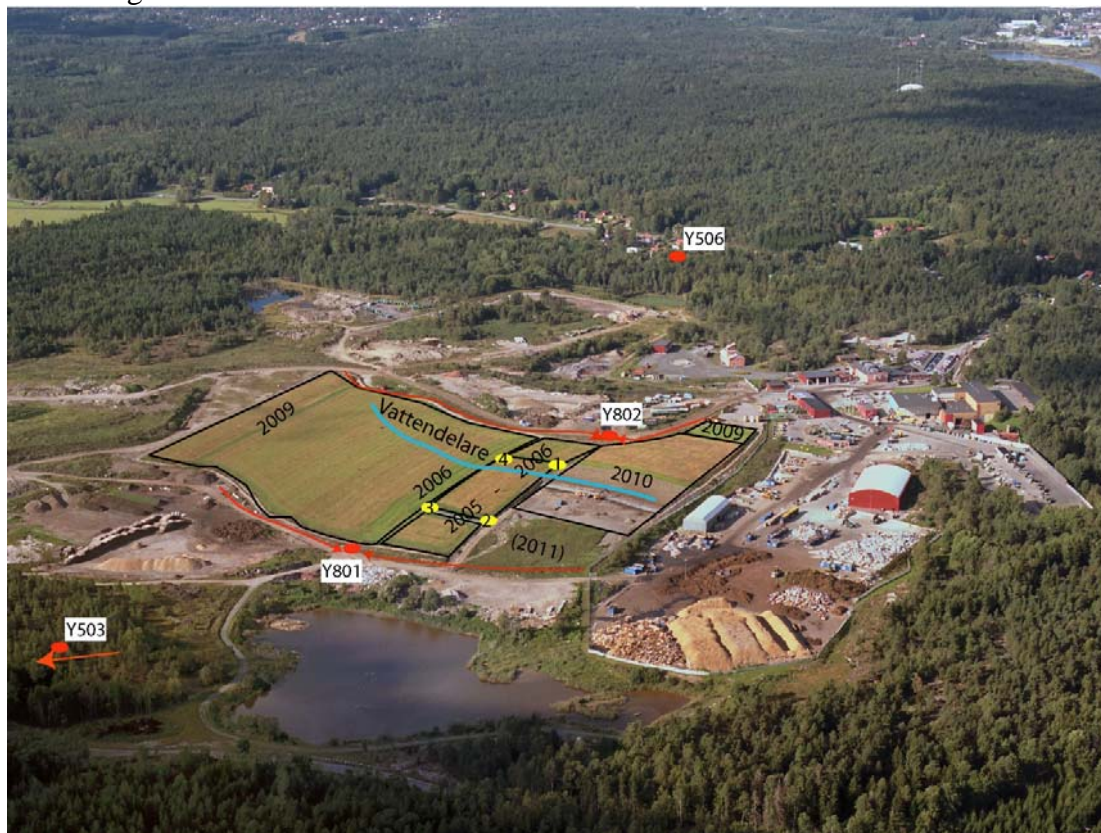
Figur 3.1 Området som är sluttäckt med FSA som tätskikt är ca 6 hektar stort. Figure 3.1 Landfill area covered with fly ash stabilized sewage sludge is ca 7 hectares.
