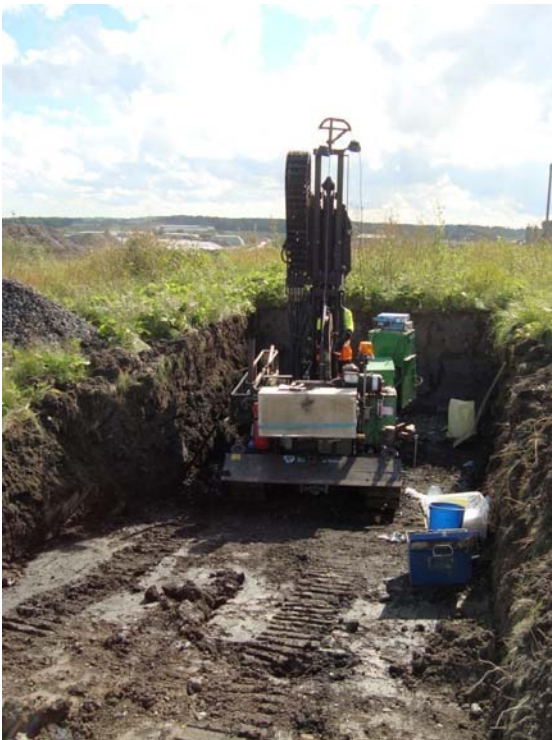
Figur 3.21 Provtagning med borrbandvagn.
