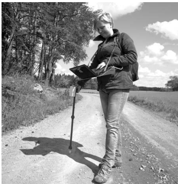
Figur 3 Civ ing. Rebecca Bertilsson, SGI, mäter den magnetiska susceptibiliteten hos ett förmodat asklager som sticker fram genom slitlagret (ljusare partier) med mätsensor MS2F som används vid detaljstudier. I ryggpåsen ligger mätutrustning, loggerdator, datainsamlingsbox, på axeln sitter en gps-mottagare, på magen sitter mät datorn och i handen har hon mätsensorn med handtag.
