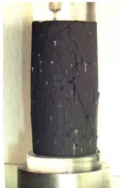
Figur 5. Provkropp efter utförd enaxligt tryckförsök efter 14 dygns härdningstid.
