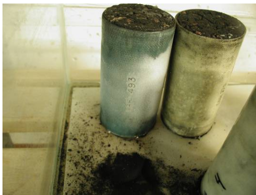
Figur 6. Frysta och upptinade prover på kapillärbädd under upptiningsfasen. Observera att material lossnar från provernas underkant.
