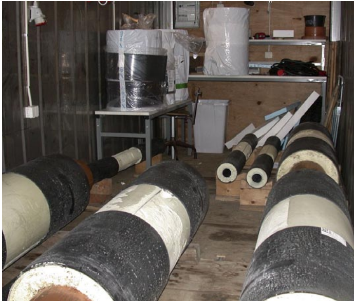
Bild 9. Provobjekt Rör och krymphylsor i kylcontainer före montage. Pipes and shrink casings in the climate chamber before installation.
