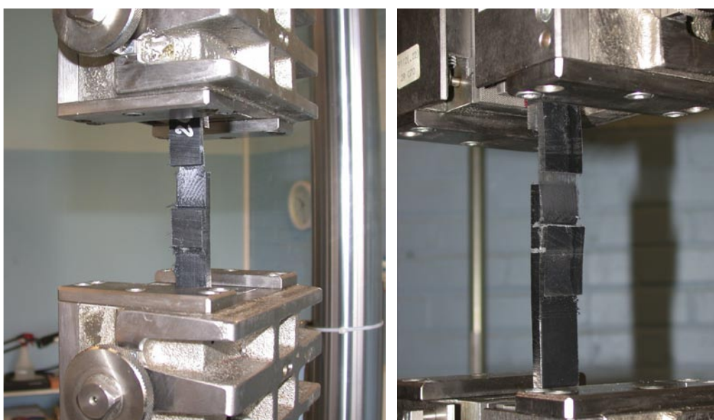
Bild 15. Skjuvhållfasthetsprovning Pågående skjuvhållfasthetsprov. Shear strength test.
