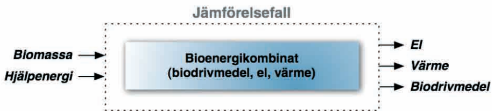
Bild 24. Systemanalysens jämförelsefall; produktion av biodrivmedel integrerat med produktion av kraftvärme
