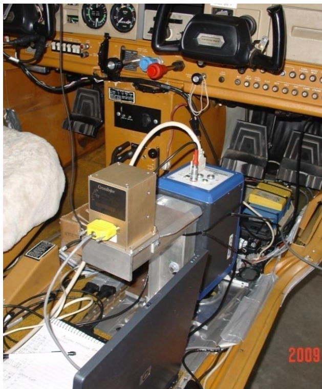
Figur 6.15. Exempel på en IR-kamerainstallation med hjälpsystem i en Cessna. IR-kameran är av typen "fotondetektor-kamera".
