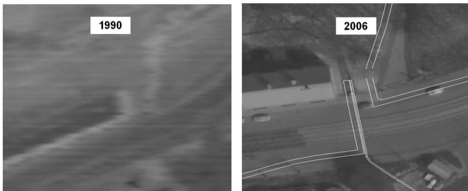
Figur A. IR-bilder tagna från 600-800 meters höjd över samma område med IR-teknik som var modern 1990 respektive 2006. Skillnaden i både termisk och spatiell upplösning är enorm, vilket har öppnat helt nya möjligheter för avancerad analys, klassificering och kvantifiering av energi- och medialäckage. Efter 2006 har utvecklingen ytterligare fortsatt, se Figur B.
