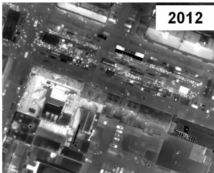
Figur 2.2. En IR-bild registrerad i januari 2012 från 800m höjd över torget i Örebro med en modern och mycket avancerad IR- kamera. Enskilda människor syns enkelt.
