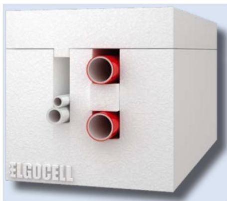
Figur 38 EPS PEX-rørsystem med varmvatten och VVC till vänster och värmens fram- och returledning till höger. Källa: Elgocell (2012)
