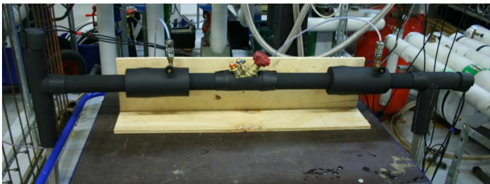
Figur 5. Testtrigg, isolerad inför mätning med tiogradigt vatten.
