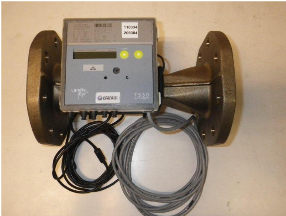
Figur 9. Provobjekt Landis+Gyr DN80.
