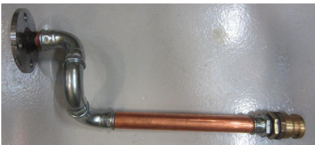
Figur 15. Två stycken 90° böjar i olika plan (skruvflöde), DN40.
