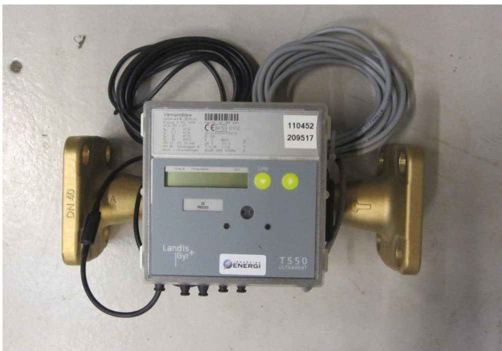
Figur 5. Provobjekt Landis+Gyr DN40.
