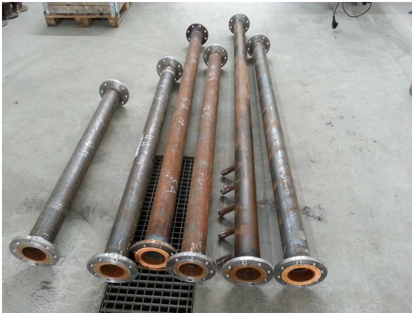
Figur. 13 Några av de rörbitar som relinats.
