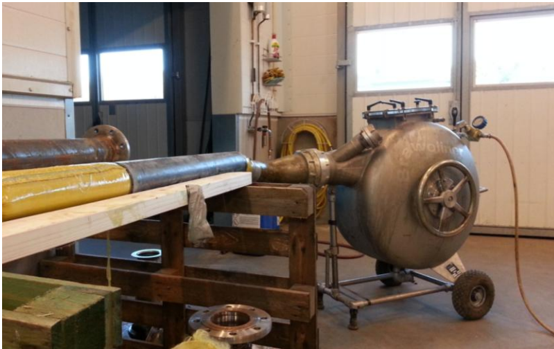
Figur 10. Trycktrumma för invrängning av foder. Notera att detta är en liten trumma som användes vid vrängning av de provbitar som installerats i testcontainern.
