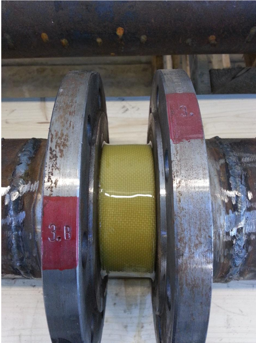
Figur 15. Närbild på uthärdat foder mellan två provbitar.
