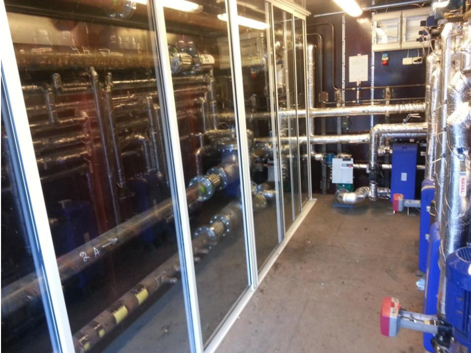
Figur 18. Här är testcontainern i full drift, man ser tydligt strumpan i hålen i teströret längst ner bakom glaset.
