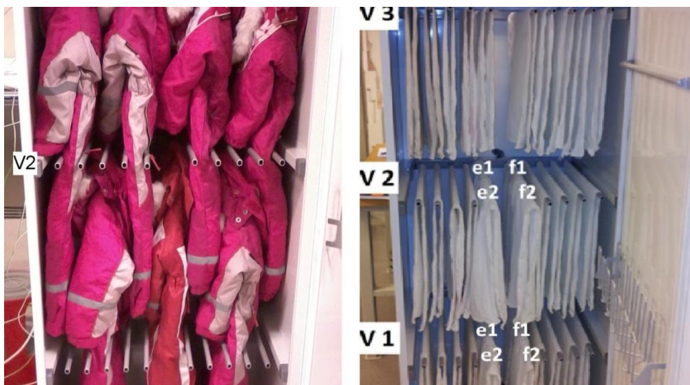
Figur 2.17. Till vänster: dagislasten inhängd i torkskåpet, till höger traslasten. Foto: Robin Johansson.
