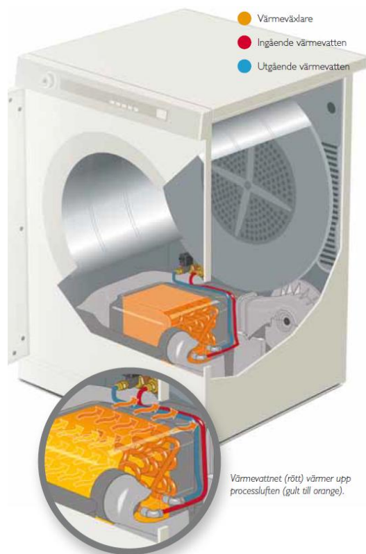
Figur 2.12. Torktumlaren med vatten-luftbatteriet. Bild från Asko Appliances AB [10].
