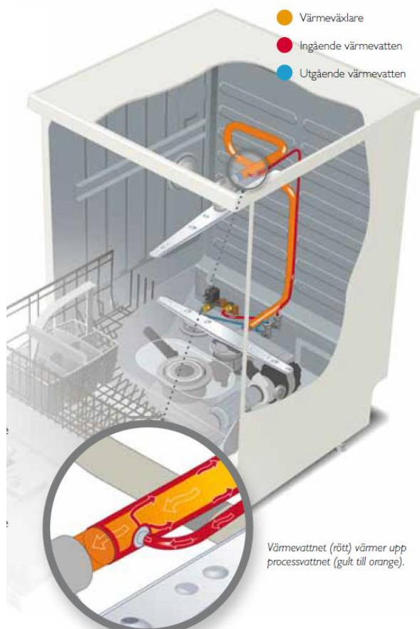
Figur 2.1. Diskmaskinen med den nyutvecklade koaxialvärmewäxlaren. Bild från Asko Appliances AB [10].
