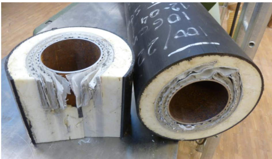
Figur 10. Bild på ett uppskuret hybridisolerat fjärrvärmerör där vakuumisoleringspanelerna har blivit genomskuren på grund av att markeringen har förskjutits relativt panelerna under polyuretanskumningen.
