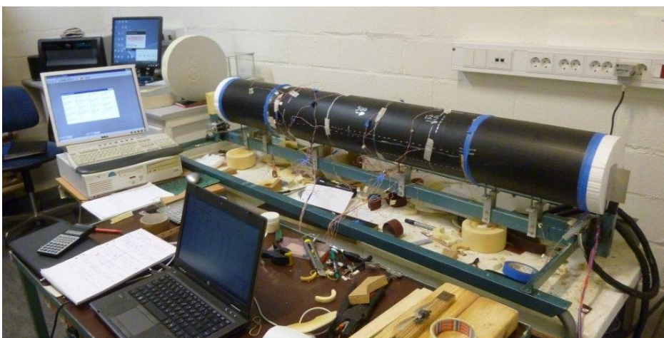
Figur 12. Provuppställning för mätning på dubbelrör med två värmestavar.
