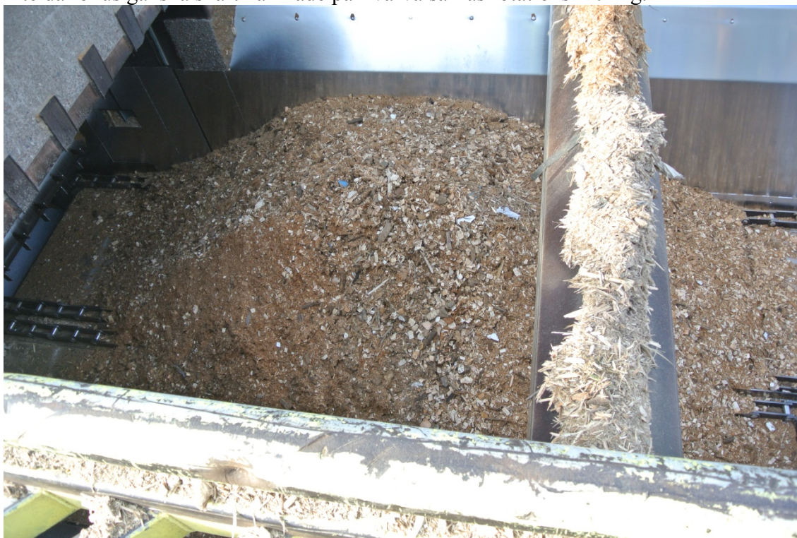
Figur 13. Mottagningsfickan under laddning med de olika lagren.
