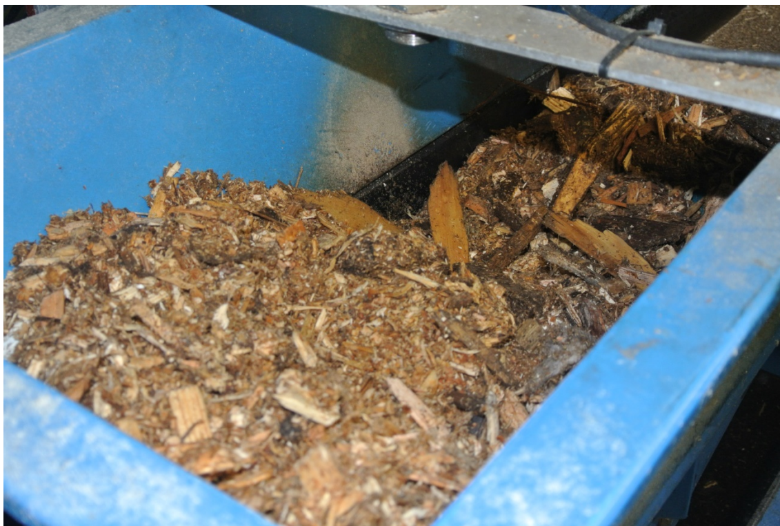
Figur 16. En provmängd under utmatning i Scanchip flisanalysator. Figure 16. One sample loaded in the analyser.
