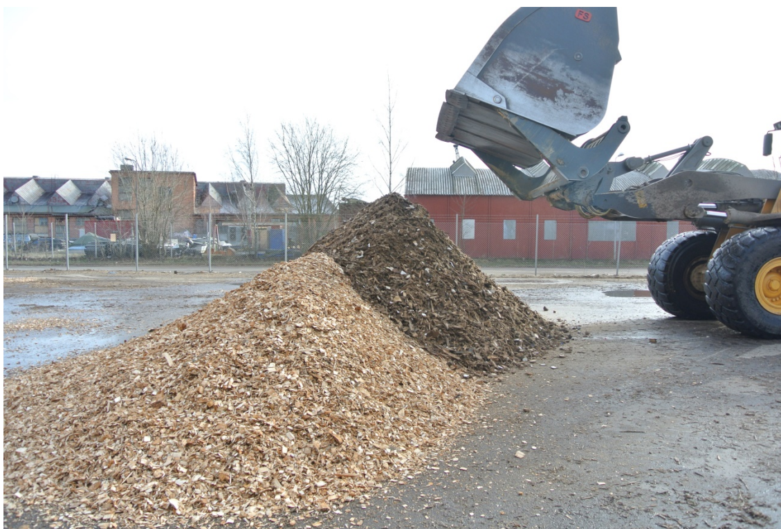
Figur 4. Chevronstacken byggs upp med stamvedsflis som första lager och importerat returträ ovanpå. Figure 4. The Chevron model is piled up with stem wood chip at the bottom layer and residue wood at top.
