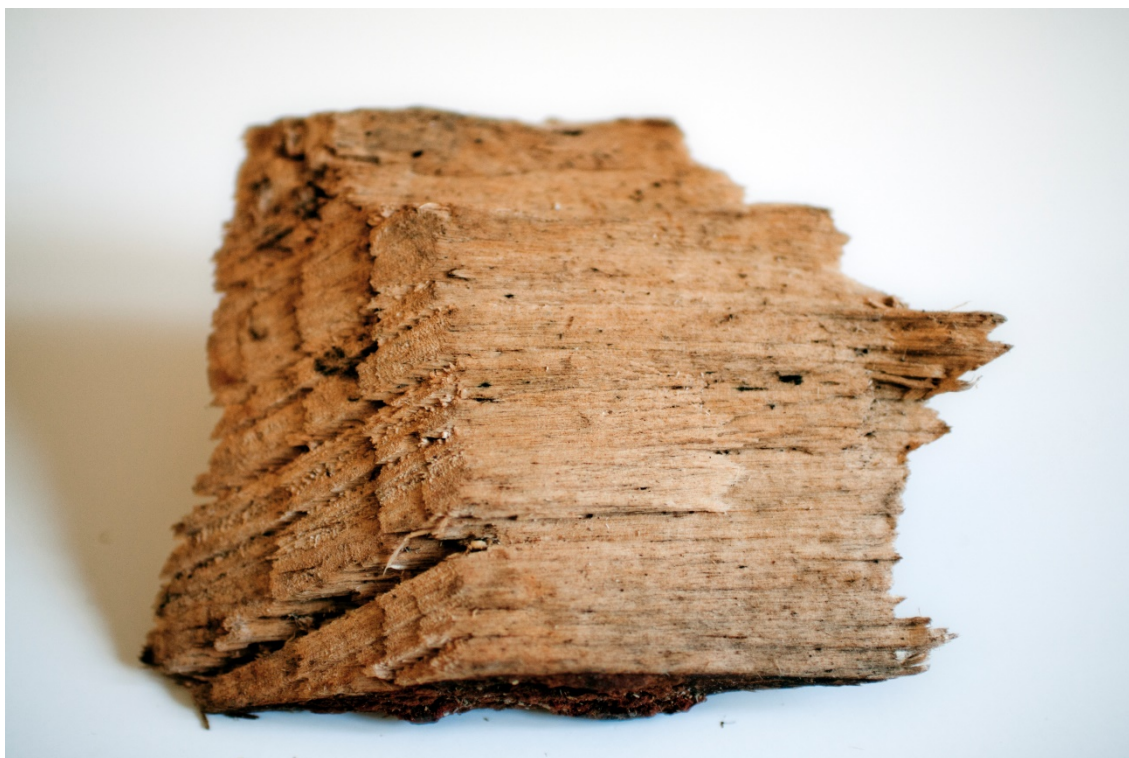
Figur 18. Typisk stamvedsflis med karakteristisk sned fas från huggstålet.
