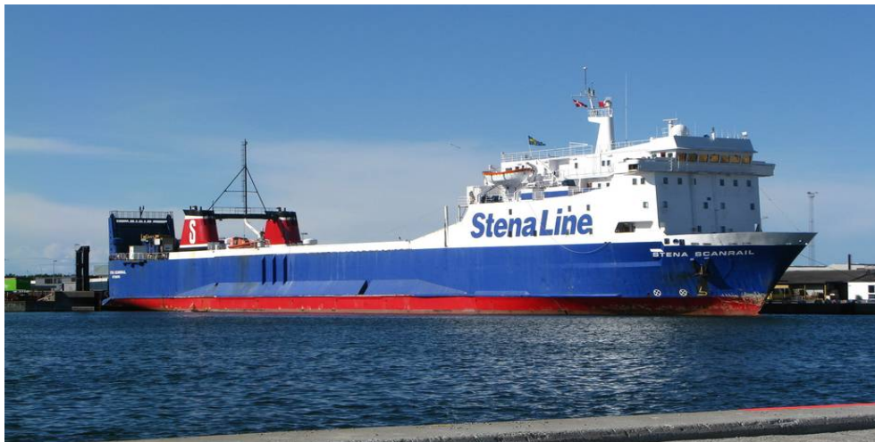
Figur 15. Stena Lines fartyg M/S Stena Scanrail vilken är ombyggd med en hjälpmotor som drivs av DME från metanol. Källa: Stena Line.
