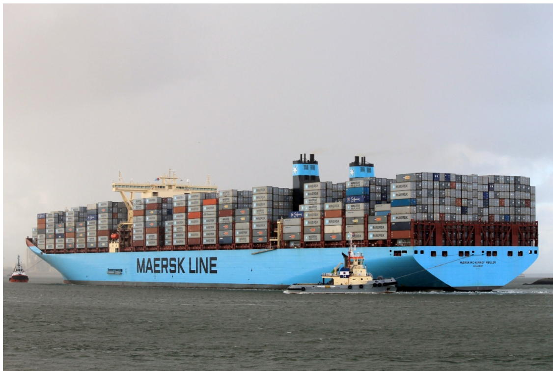
Figur 14. M/V Mærsk Mc-Kinney Møller, världens största containerfartyg. Fartyget är cirka 400 meter långt och 59 meter brett och kan hålla 18 270 containrar. Källa: Maersk.
