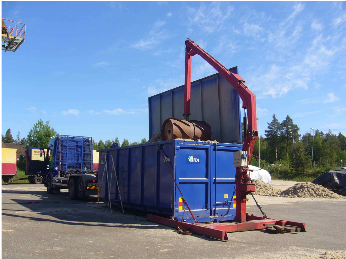
Figur 5. Visar Roll-Pac-komprimatorns placering vid en container och hur rollen rullar och komprimerar hampan. Foto Yvonne Söderström
