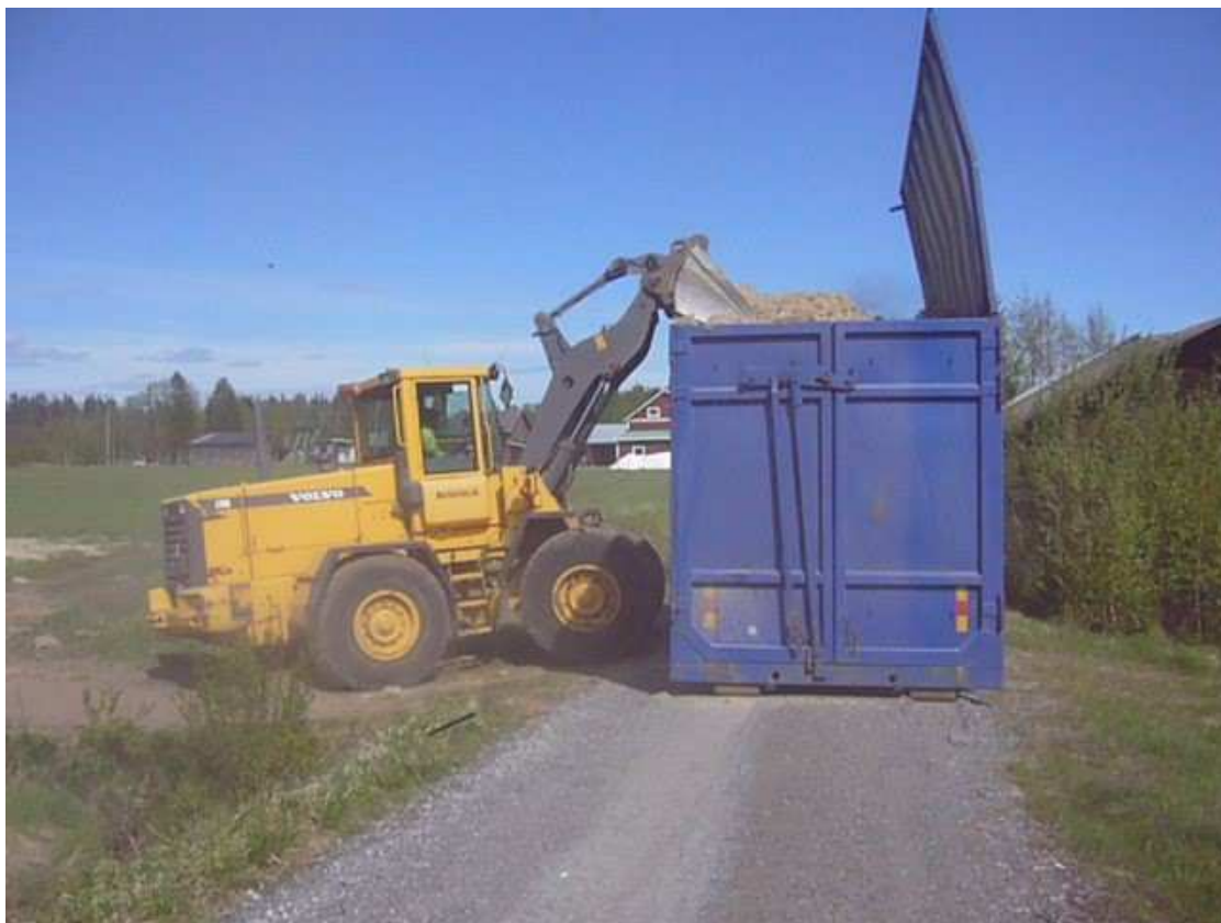
Figur 4. Traktor komprimerar hampan med skopan i en 38 m 3 container. Foto Yvonne Söderström
