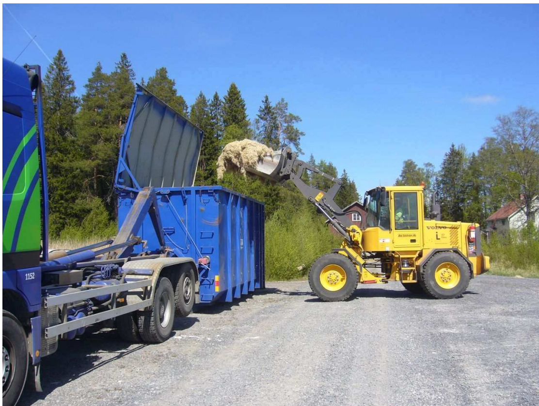
Figur 3. Traktor som fyller en 38 m 3 container med lös hackad hampa utan att komprimera. Detta försök ska fungera som en referens till de kommande komprimeringsförsöken. Foto Yvonne Söderström
