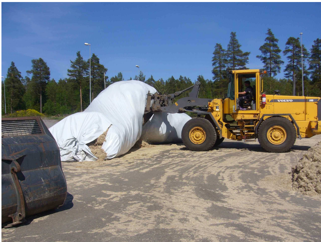
Figur 8. Traktor försöker lyfta "slangen" med pallgafflar till ett lastbilsflak. Slangen gav vika och plasten gick sönder. Foto Yvonne Söderström
