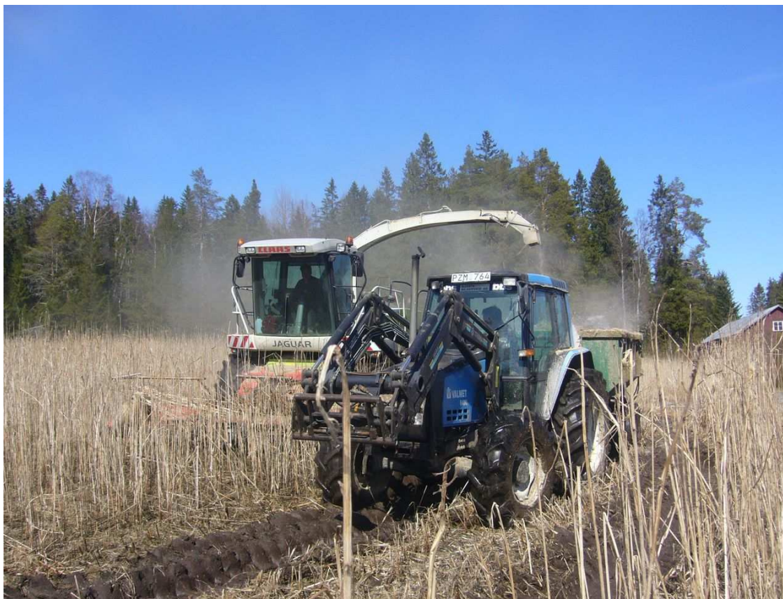
Figur 1. Skörd av hampa våren 2008. Det skördades med en Jaguarhack med majsbord. Test gjordes för att visa hur mycket hampan komprimerades direkt från skördemaskinen. Foto Yvonne Söderström
