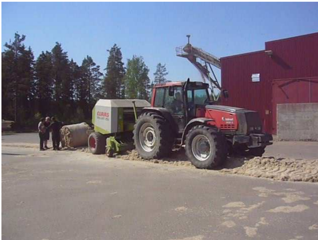
Figur 12. Hackad hampa som har komprimerats med en Rundbalspress. Efter balen syns en ca 15 centimeters tjock "matta" av skävor som har sållats bort från balpressen. Foto Yvonne Söderström
