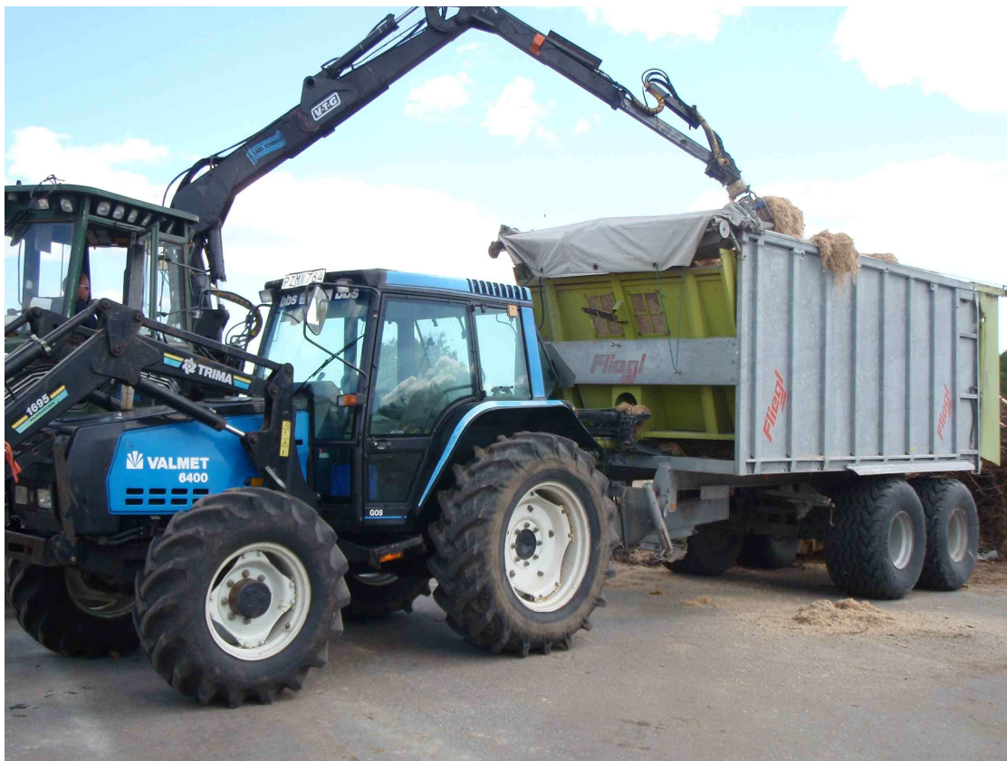
Figur 14. Bilden visar när framgaveln var i framkant och bakgaveln var nerfälld. Skotaren fyllde vagnen med hampa med hjälp av en grip. Foto Yvonne Söderström
