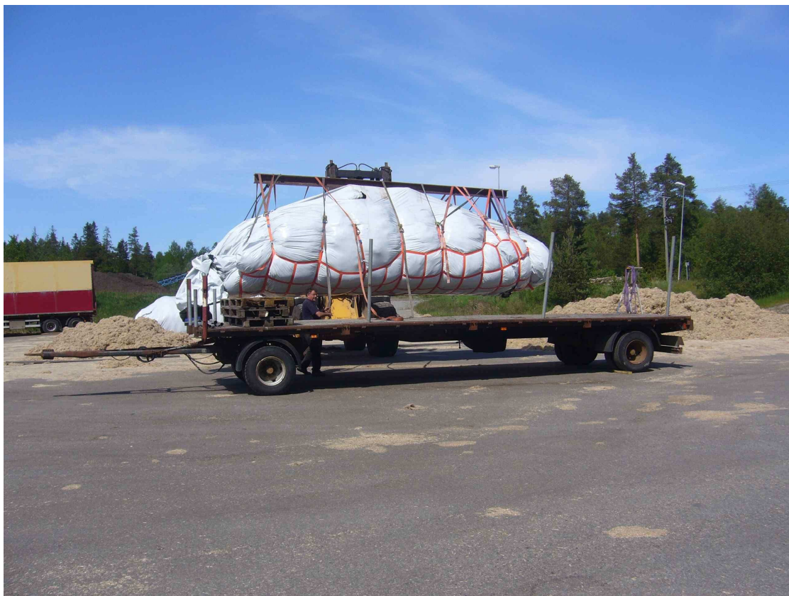
Figur 9. Lastning av slang med hjälp av ett cargonät för vidare transport till virkesterminalen för vägning. Foto Yvonne Söderström
