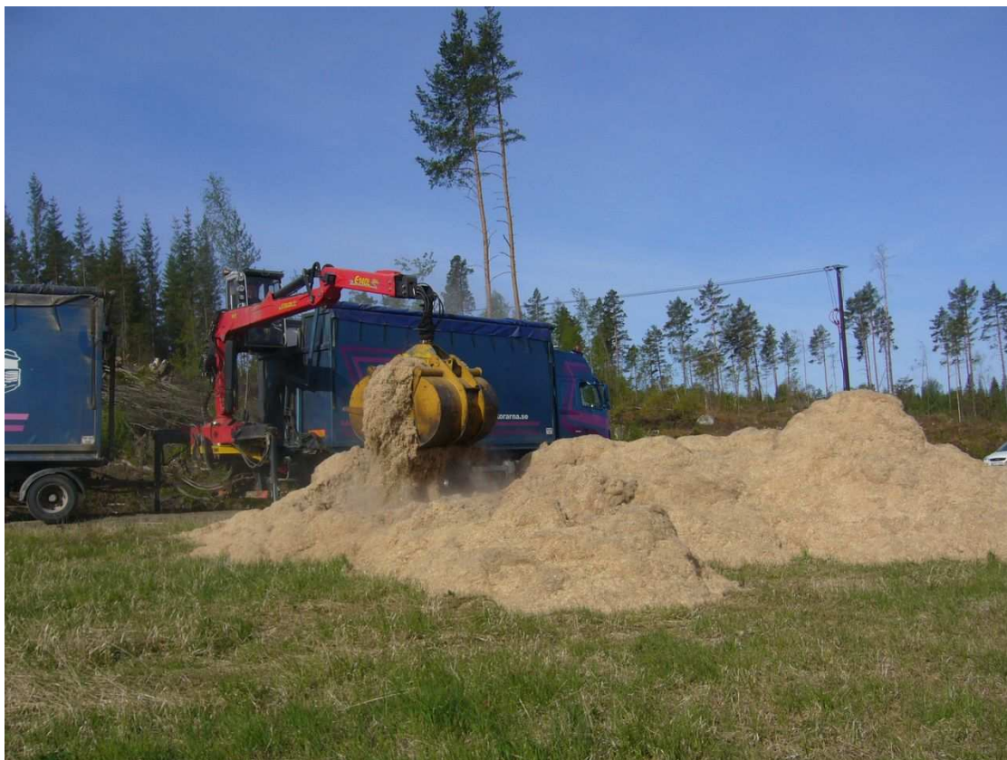
Figur 2. Lastning och komprimering av hackad hampa med en kran med skopa. Foto Yvonne Söderström
