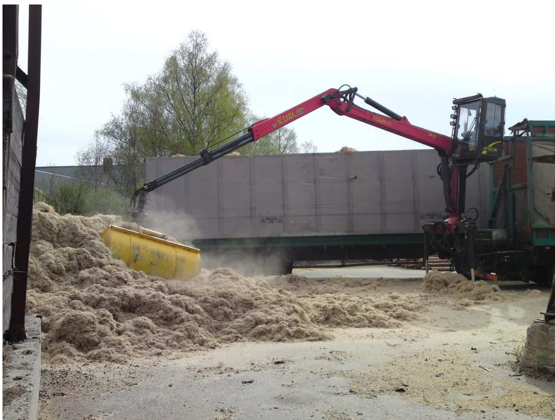
Figur 15. Lastning med en flisbil som har kran och skopa. Hampan komprimerades sedan med hjälp av skopan. Foto Yvonne Söderström
