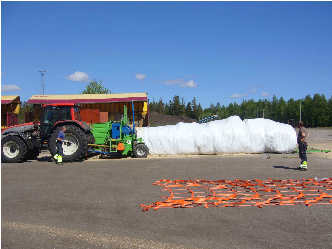
Figur 7. Hampan komprimerades med en slangpress på terminalen i Dombäck. Närmast ligger ett cargonät som skulle användas till att lyfta slangen. Foto Yvonne Söderström
