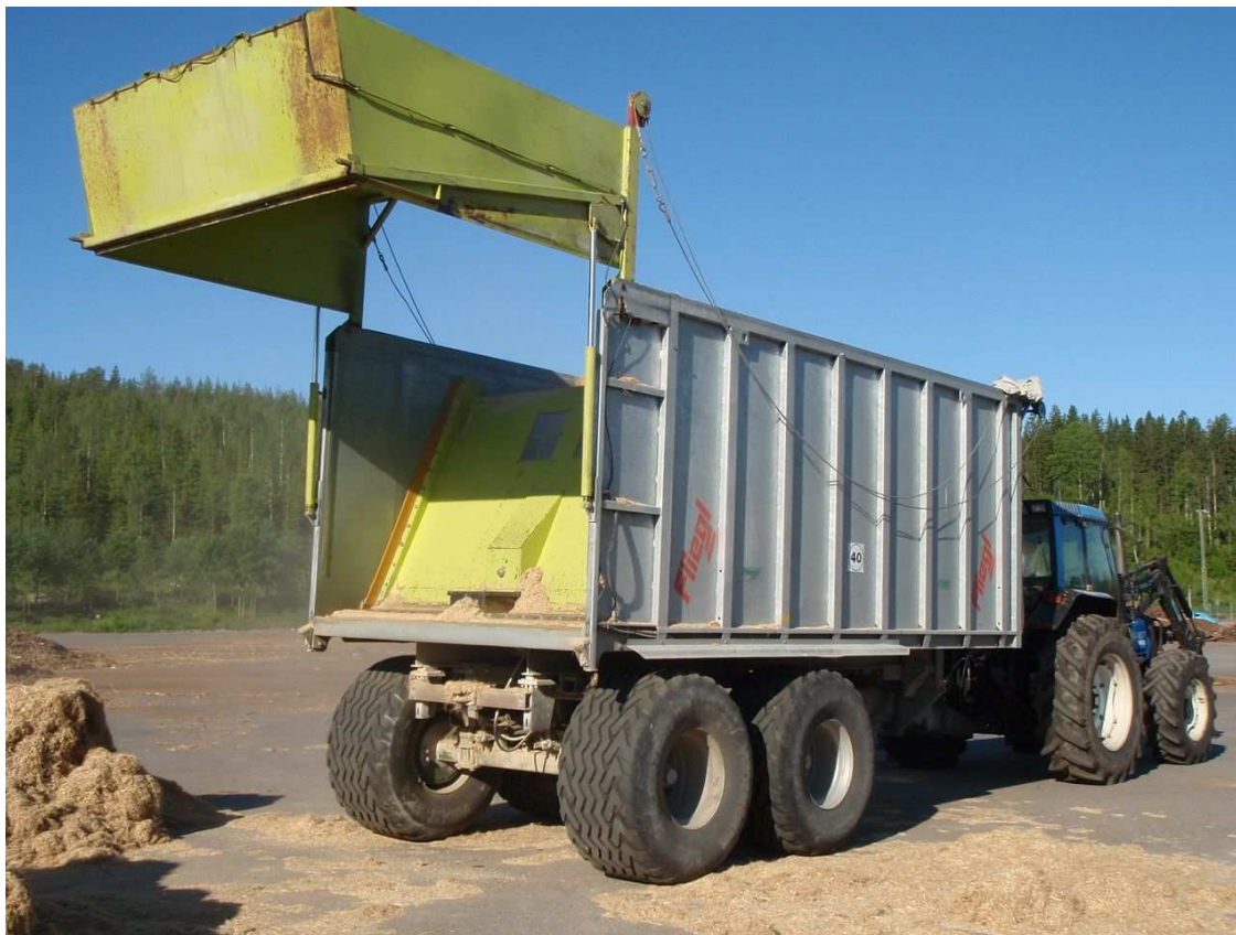
Figur 13. Bilden visar när den gröna framgaveln har förskjutits bakåt i vagnen och när bakgaveln är upplyft. Foto Yvonne Söderström
