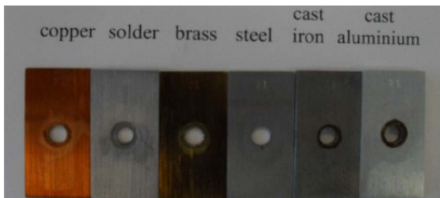
Figur 2. Foto på testbitar efter genomfört test (Älvkarleby).
