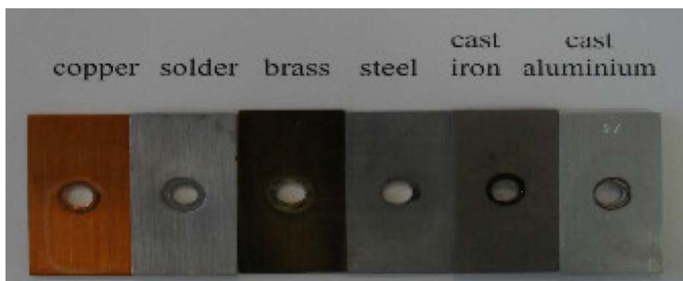
Figur 3. Foto på testbitar efter genomfört test (Åtorp).
