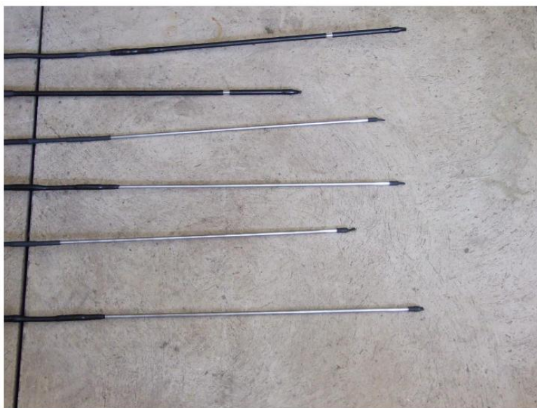
Figur 4-3 Nedre del av mätsond för bestämning av gropfrätningshastighet i betong.
