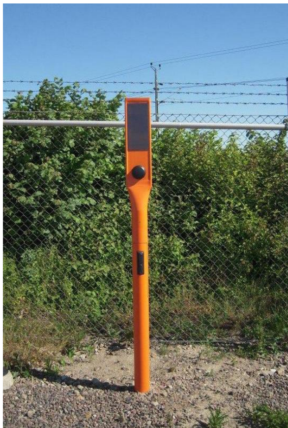
Figur 4-1 Korrosionssond för indikering av frätgropsdjup hos naturgasledningar.
