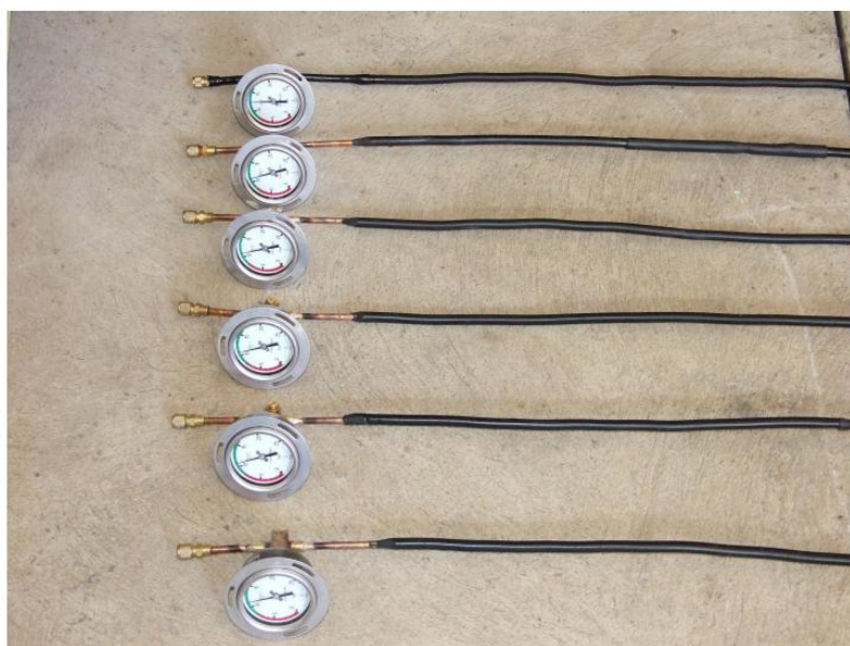
Figur 4-2 Övre del av mätsond för bestämning av gropfrätningshastighet i betong.
