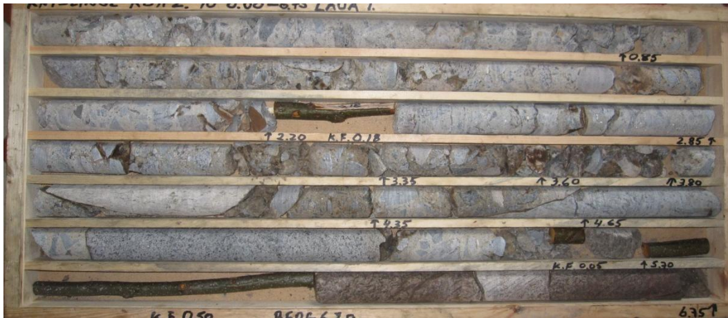
Figur 3-9 Borrkärnor från zonen mellan berg och betong.
