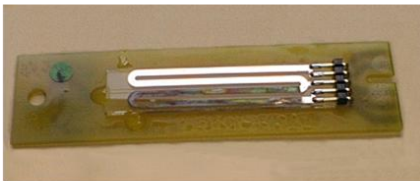
Figur 4-4 Resistanssensor (Rohrback), den övre blanka metallslingan är lackerad och utgör referens.
