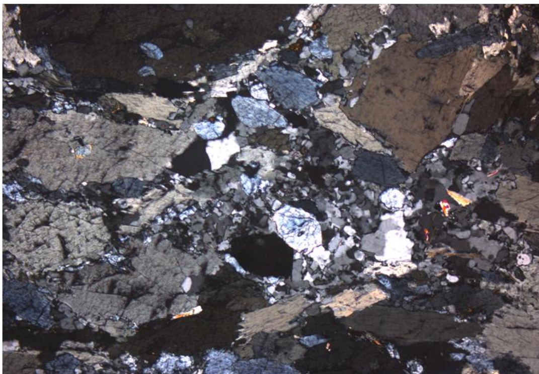
Figur 4. Prov A3, från Ajaure. Djup i betongen: 15 mm. Tunnslip, genomfallande polariserat ljus. Området i bilden är 1,7 mm brett.
