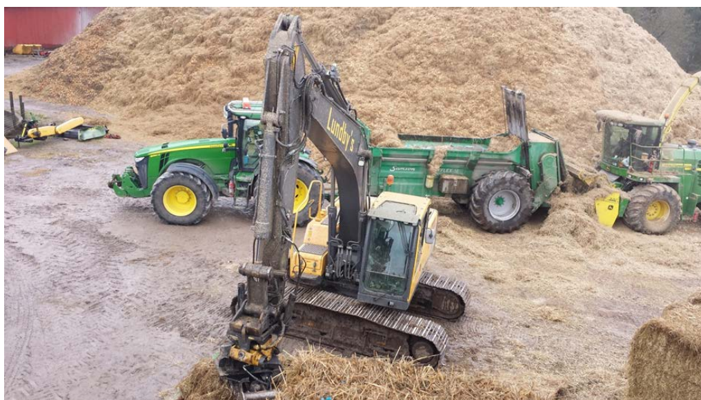
Figur 2. Sönderdelning av halm i en halmsnittare.
