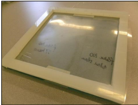
Figur 11 Tillverkningsram och färdigt laminat med hål borrade för polyetenramen
