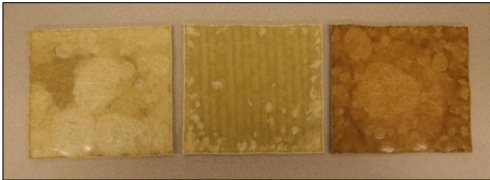
Figur 34 Första provserien efter exponering för 200°C
