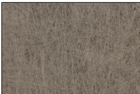
Figure 1 CSM, matta av huggen fiber (300-450 g/m 2 )
