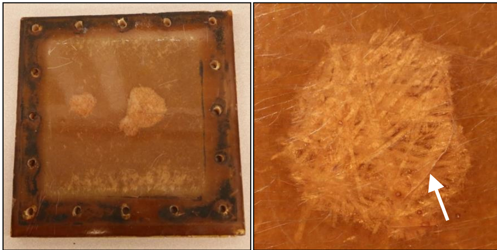
Figur 26 Laminat IV-B efter att ha torkat fem dagar efter avslutad exponering. Ökad vitning kring glasfibrerna syns tydligt t.v. En spricka i delamineringen observerades, t.h.
