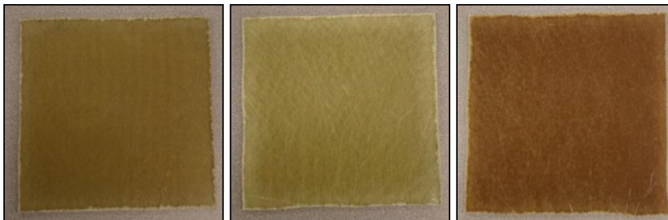
Figur 33 Laminaten efter exponering för vatten vid 80°C
