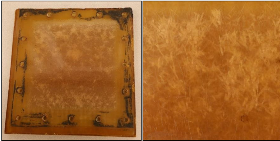
Figur 24 Laminat III-A efter att ha torkat fem dagar efter avslutad exponering.
