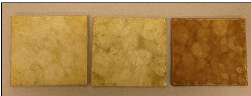
Figur 35 Andra provserien efter exponering för 200°C
