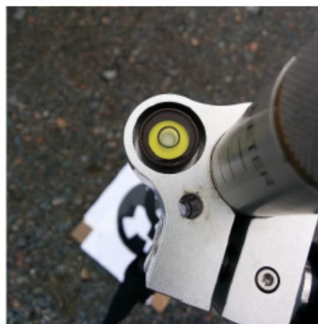
Figur 2. Finjustering av prisma med avseende på nedsättningspunkt och lodlinje.
