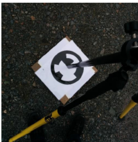
Figur 2. Finjustering av prisma med avseende på nedsättningspunkt och lodlinje.
