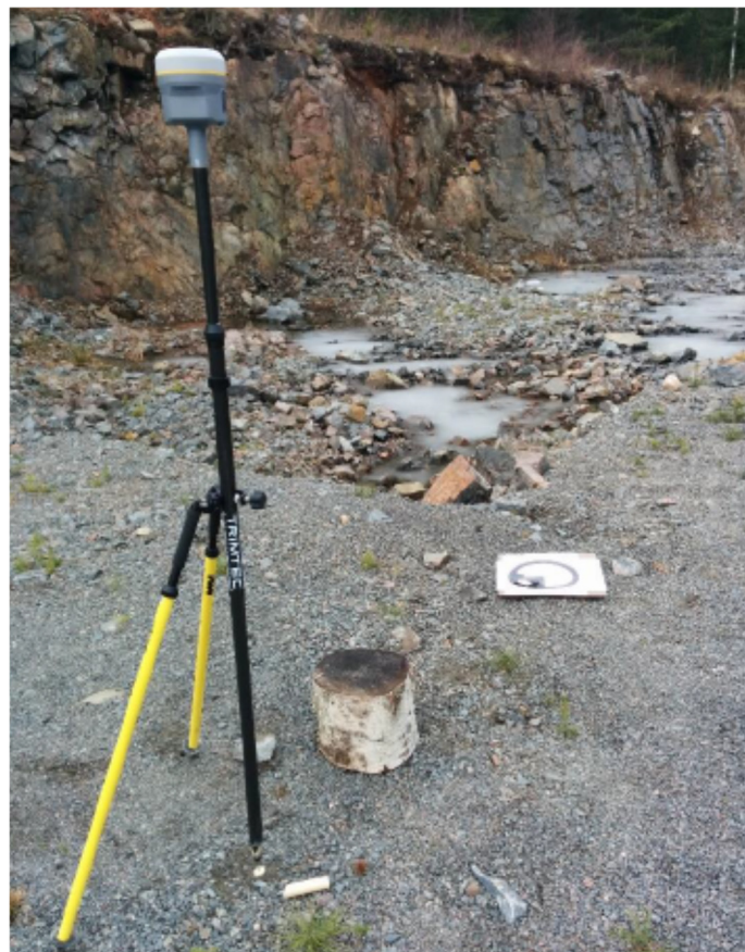
Figur 3. Inmätning med nätverks-RTK av bakåtpunkt markerad med rundstav nedslagen i marken.
