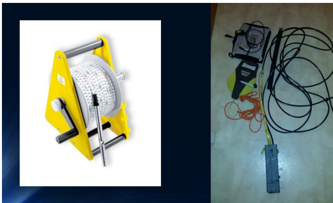
Figur 6 Vanligt ljuslod till vänster och alternativ med tryckgivare fäst på måttband till höger.
