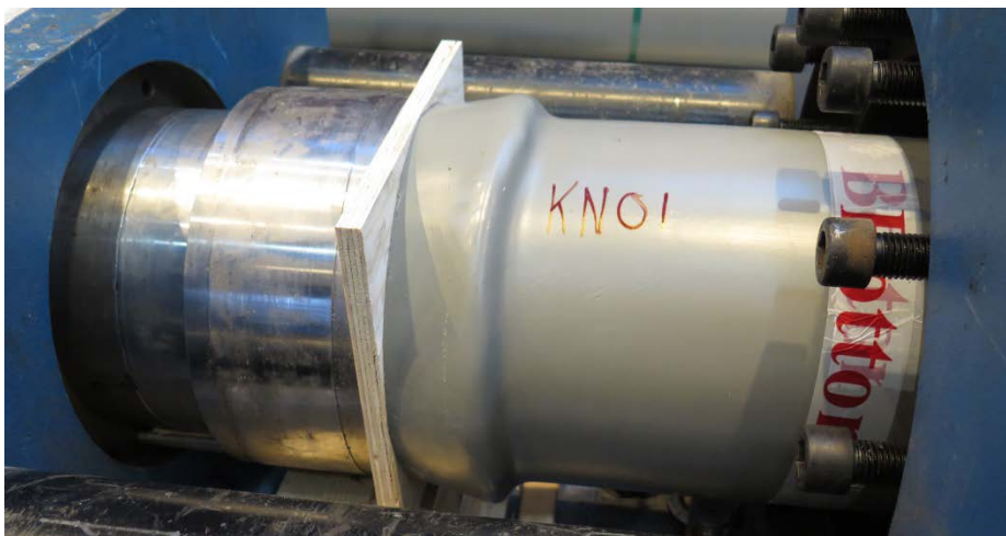
Figur 9: Bilden visar intryckningen av bottenpluggen som tros ligga bakom att den axiella lasten sjunker något när den når upp till cirka 200 kN. Bilden kommer från prov KN01.
