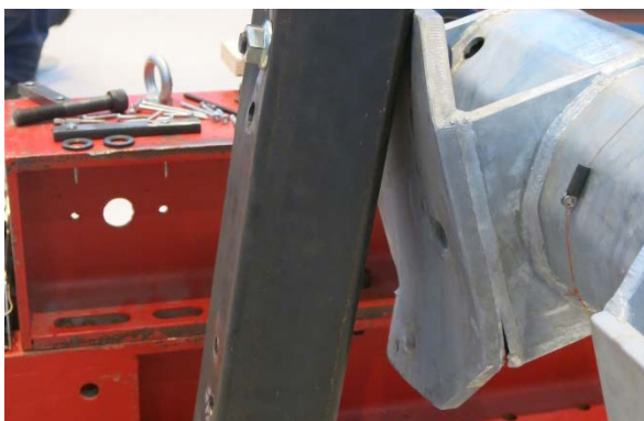
Figur 37: Skadad infästningsdetalj till följd av vridande last. Bild från prov VR17.
