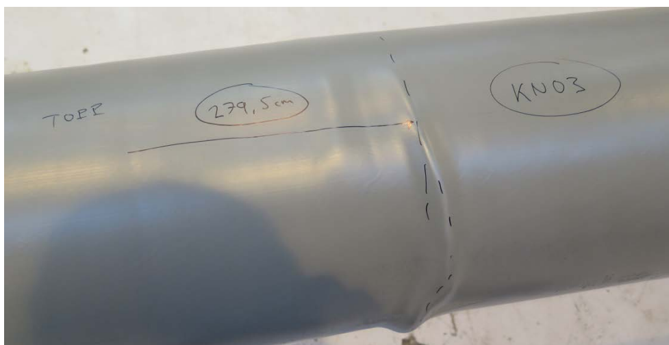
Figur 10: Trolig skada på det lastbärande innerröret till följd av knäcklasten. Bild från prov KN03.
