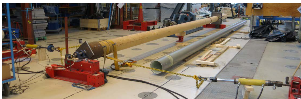
Figur 30: Provuppställning som användes för vridproven av stolparna från Fabrikat 2, Fabrikat 1 samt Fabrikat 3. Stolparna från Fabrikat 4 provades med en något modifierad provuppställning.
