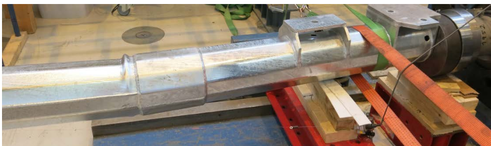
Figur 14: Buckling till följd av knäcklast, bild från prov KN18.
