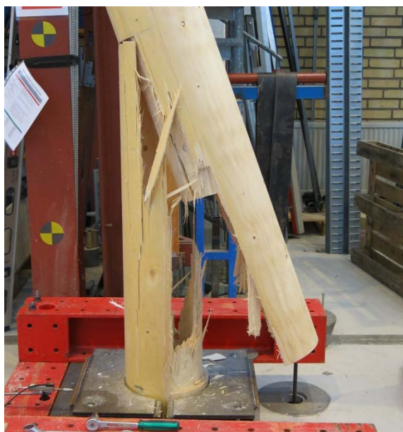
Figur 25: Stolpbrott på grund av böjande last, bild från prov B08.
