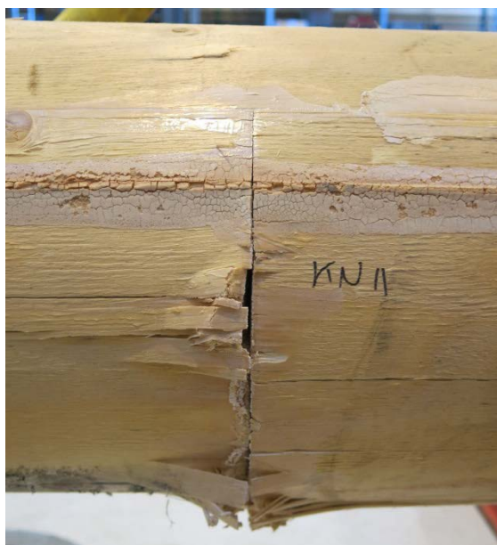
Figur 12: Begynnande skada i den yttre limfogen. Bild från prov KN11.
