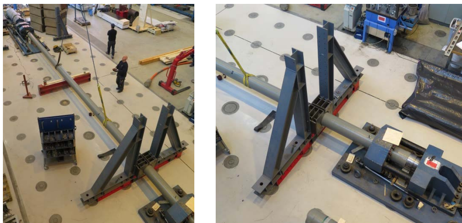
Figur 5: Provuppställningen som användes för knäckproven. Den högra bilden visar den fasta inspänningen av rotändan.
