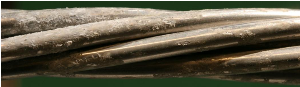
Figur A.18 Bild av trådarna i kärnan av lina 7, som i likhet med de i lina 6 är belagda med korrosionsprodukter.
