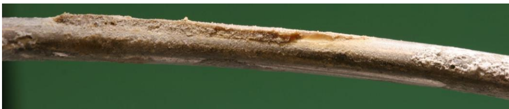
Figur A.19 Bild av rester av vax på ytan av kärntråden från lina 8. Detta skiljer lina 7 från lina 6.
