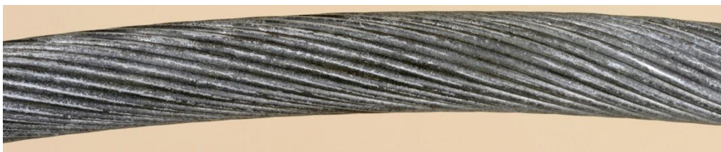
Figur A.20 Vy av sidan med den mörka beläggningen på lina 8.
