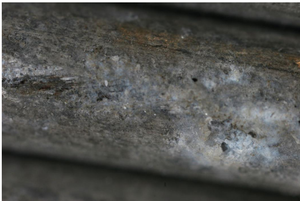
Figur A.9 Bild av angrepp på tråd i lina 4 på vilken syns gropar omgivna av hydroxid och till vänster om gropen hur oxiden i trådens yta börjar brytas upp.
