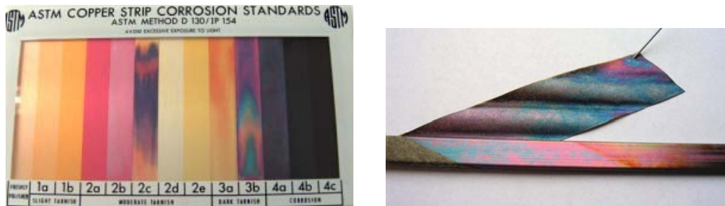
Figur 7 Olika grad av kopparkorrosion enligt ASTM
