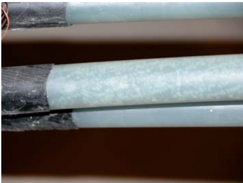
Figur 7.7: Bilde av isolasjonen for kabel 6. De hvite 'flekkene' for midtfasen er vanntrær som vokser fra lederskjermen og utover mot ytre halvleder.
