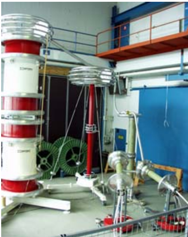
Figur 4.2.1 Testuppställning för genomslagsprov (AC step test i Sverige)
