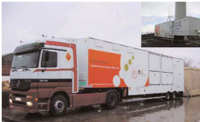
Figur 4.8 Spansk mobil valideringsutrustning "ULISES" för spänningssänkningar.
