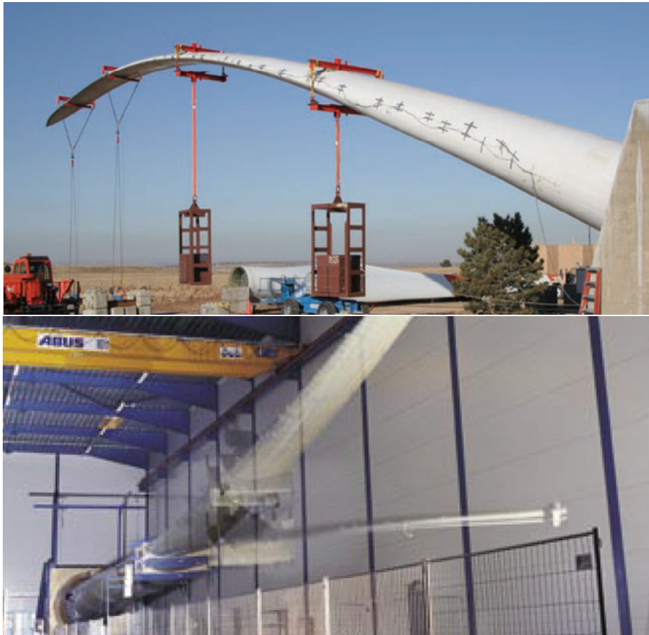
Figur 3.3 Bladprovning. (över) Statisk hållfasthet. (under) Utmattningsprovning. Källa: NREL.
