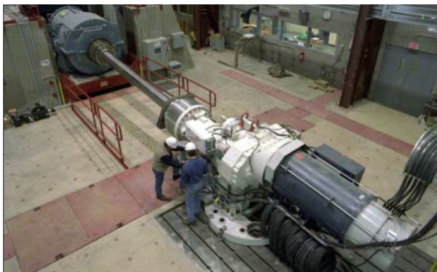
Figur 5.1 Dynamometer på 2,5 MW för provning av drivlina. Källa: NREL.
