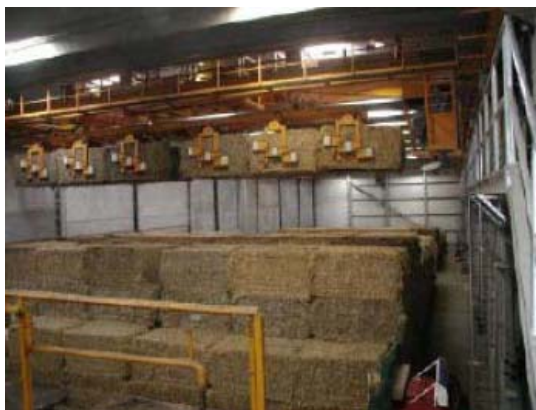
Figur 12. En kran flyttar balarna till lagringsplatsen [35]
