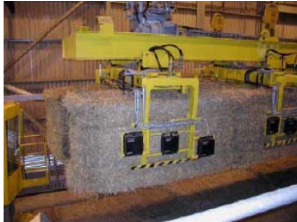
Figur 11. Balkran med fukthaltsmätning [35]
