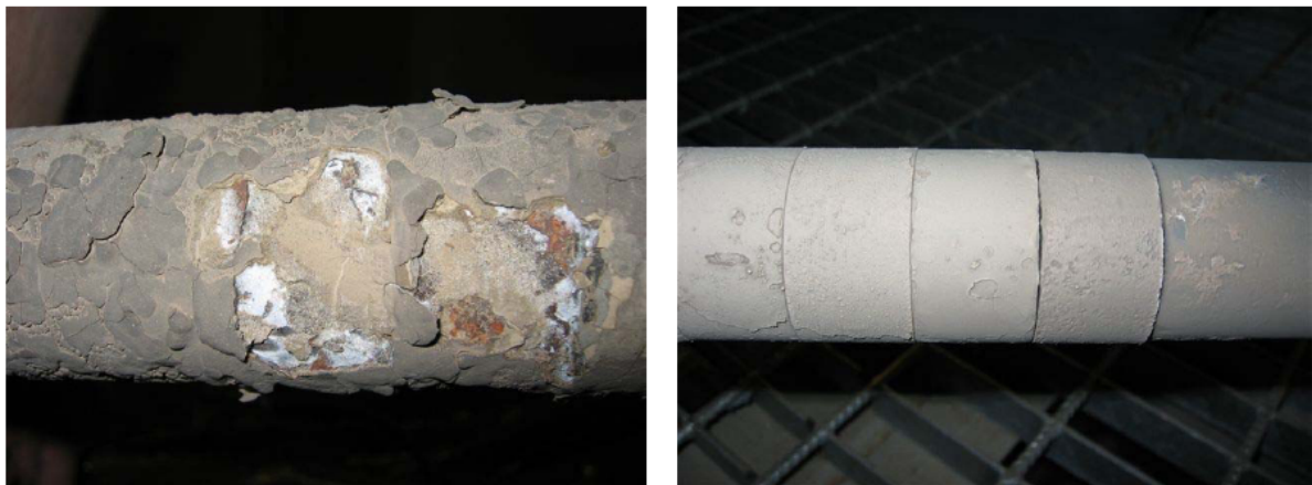
Figur 15. Beläggningssond som utsatts för rökgasen i Munksunds CFB-panna. Bilden till vänster visar beläggningarna som bildas utan svaveltillsats och bilden till höger med svaveltillsats (ammoniumsulfat) [2]
