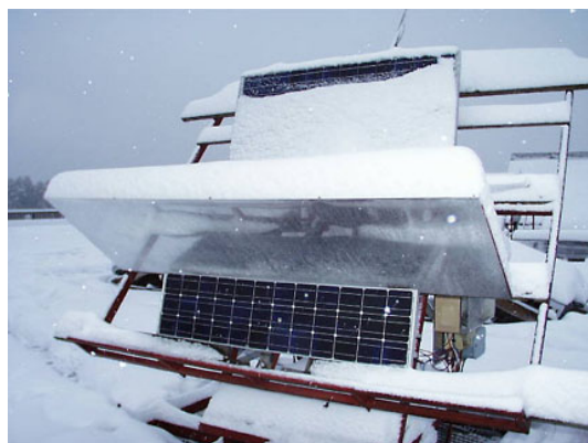
Figur 5 Tidig provuppställning vid Vattenfall Utveckling AB med överliggande reflektor, referensmodulen ovanför är snötäckt.
