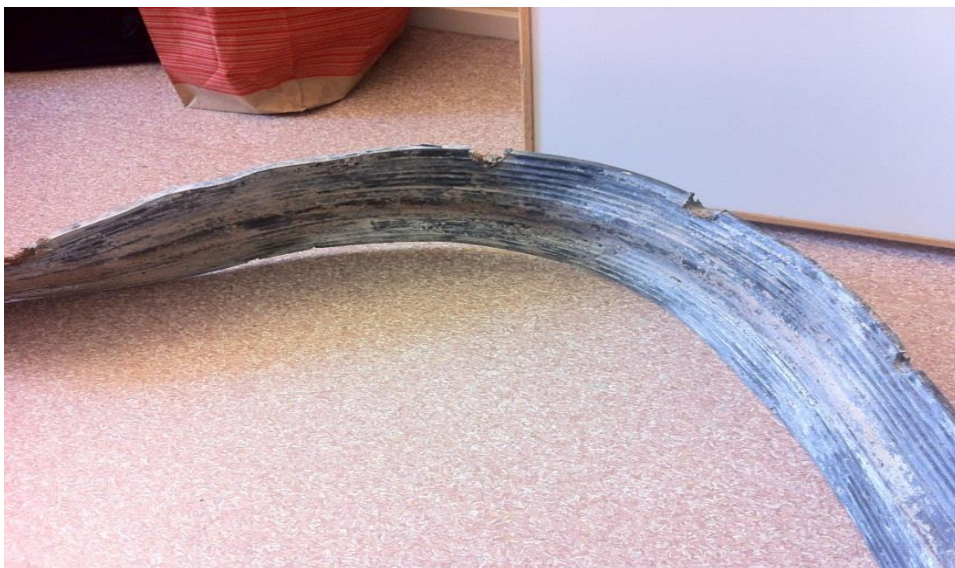
Figur 4. Ett gammalt PVC-fogband från kylvattenvägarna på Ringhals. Fogbandet kändes mycket styvt och hade förlorat sin flexibilitet.
