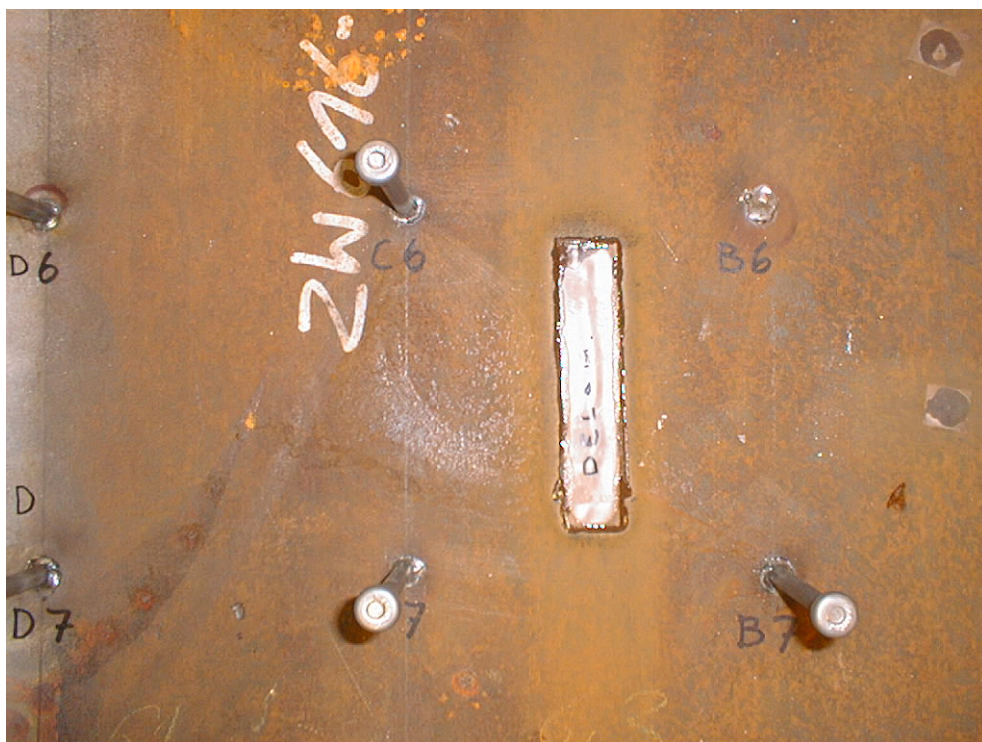
Figur 1. En rektangulär "delaminering" i fältet BC67. Plastfilmen är klistrad mot stålplåten längs plastens kant.
