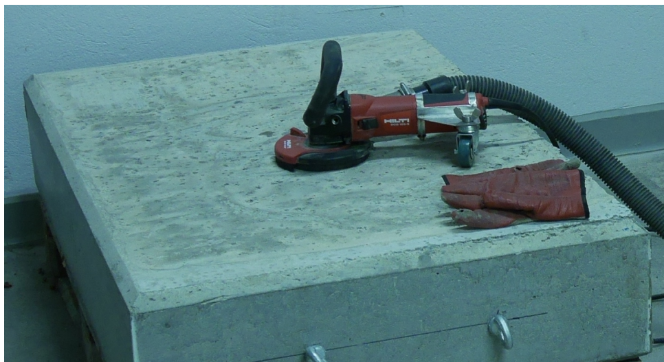
FIGUR 7. Denna lätt modifierade (notera stödhjulen) diamantslipmaskin användes för att slipa ner ytan.
