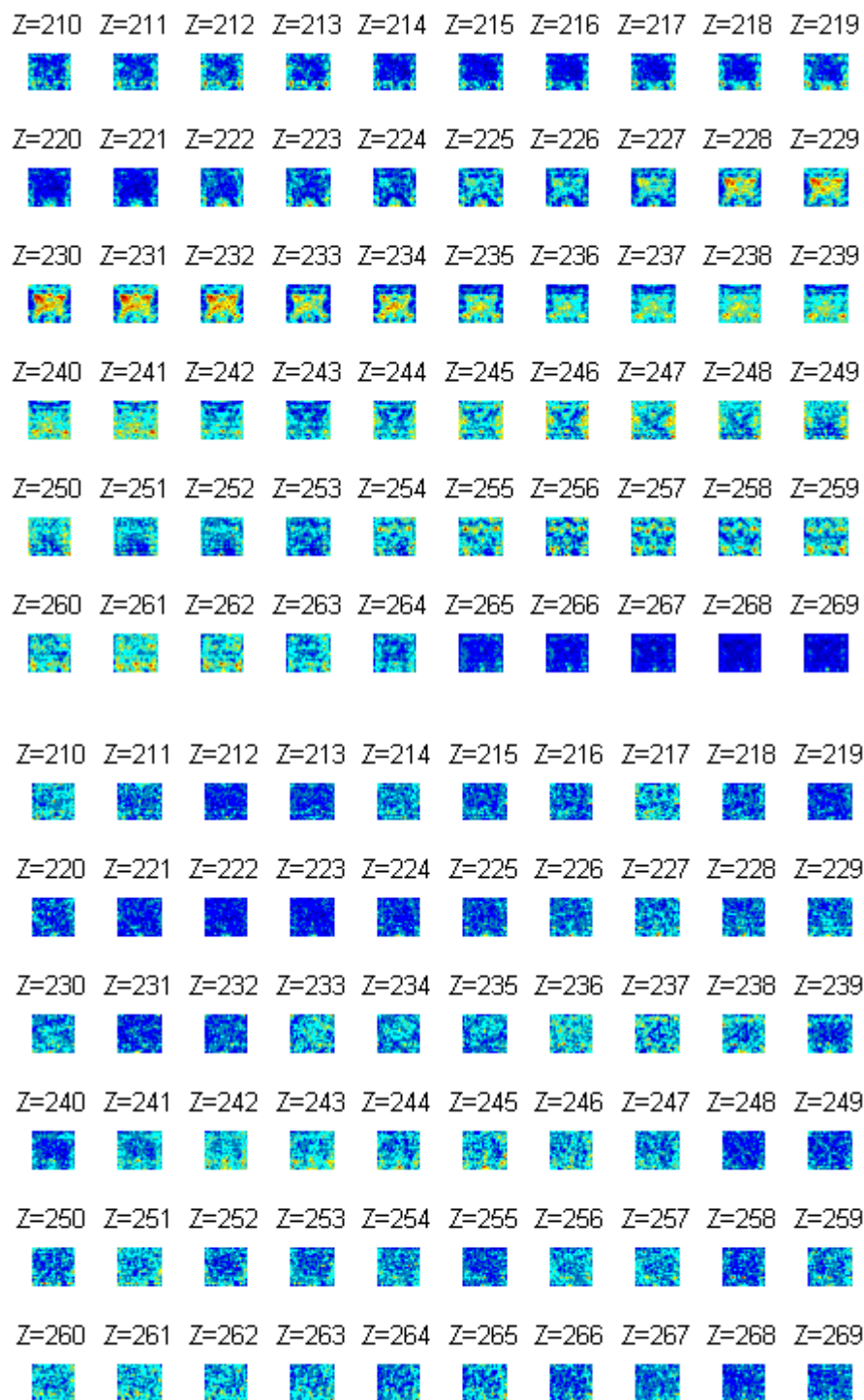
Figur 24. Försök F9. Överst: Direkt signal från förförstärkaren. Underst: Högpasfilterad signal med förstärkt "Harmonic imaging". Timeslice 210-269. Notera att endast drygt halva provkroppen avbildas eftersom mätningen ofrivilligt avbröts.
