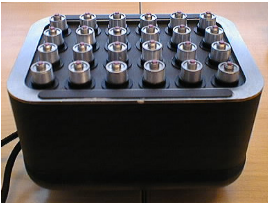
Figur 9. ACSYS A1220 sensor med 12 TX och 12 RX stift avsedd för torrkoppling mot betong.
