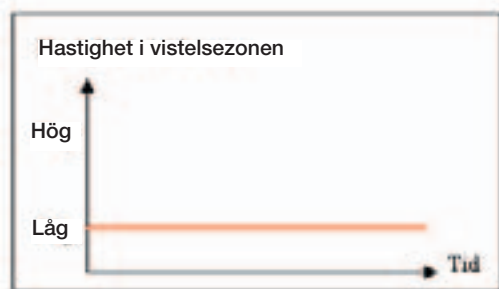
Kontrollgrupp: deplacerande ventilation inga variationer
