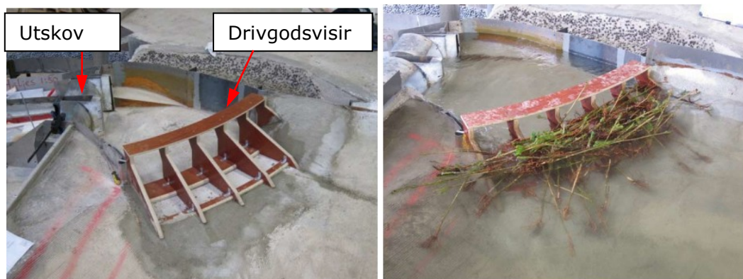
Figur 4. Modellförsök med drivgodsvisir i Höljes.
