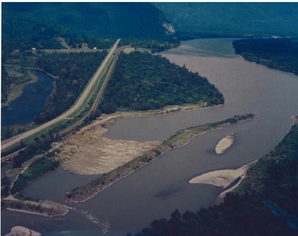
Figur 2. Frazer river debris trap utnyttjar kurvan åt vänster som för över drivgodset till högra sidan.
