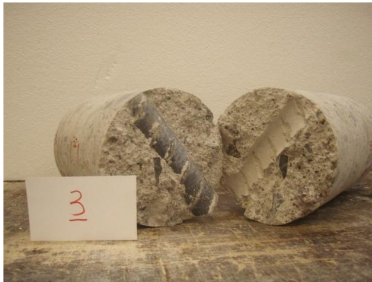
Figur 3 Armering i borrkärna 3.
