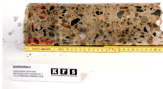
Figur 2 Borrkärnor för kemisk analys. Borrkärnornas vänstra sida är intags- sumpens yta.
