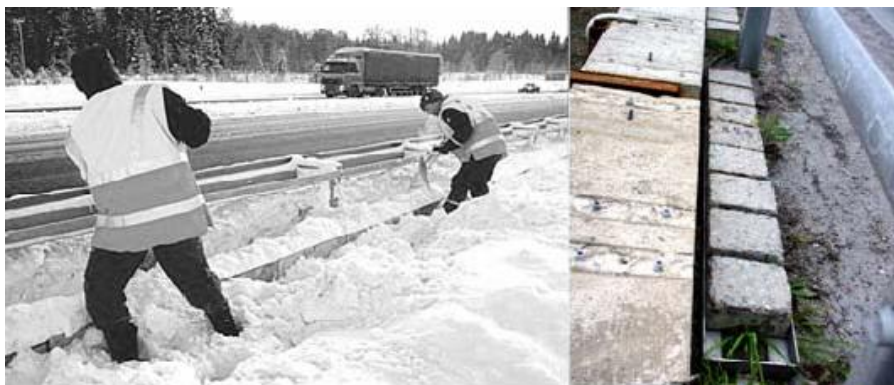
Figur 4.4. Fältprovning vid riksväg 40. Betongproverna skyddas av ett stål-räcke. Från
