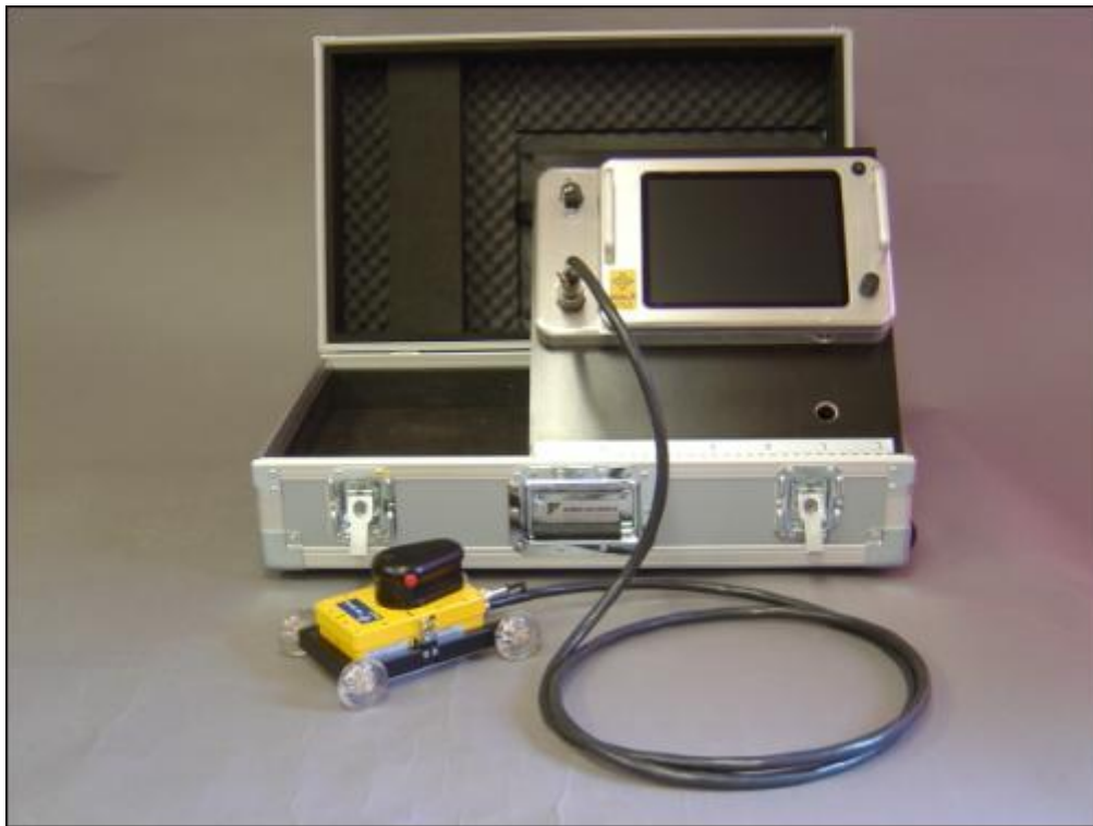
Figur 3.4 Monitorn CX11, monterat i transportväska, med 1.6 GHz antenn ansluten. Datainsamlingen sköts med fjärrkontroll (två knappar) på antennen.
