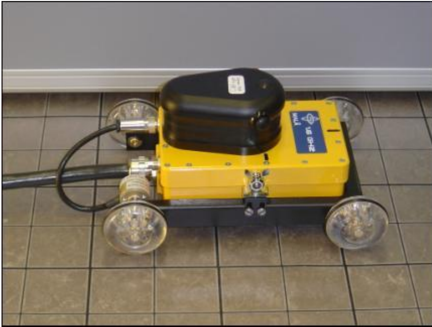
Figur 3.5 Närbild på den handhållna antennen, överföringskabeln syns till vänster i figuren.
