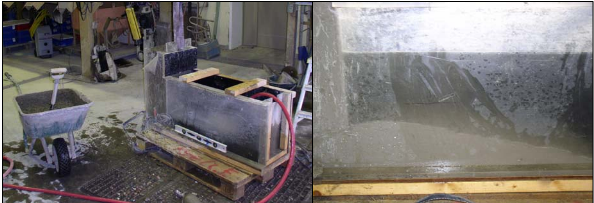
Figur 3.2: Försöksuppställning med den modifierade L-lådan (vänster), bild från försök (höger).
