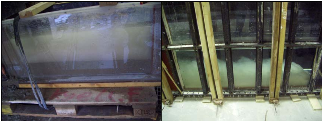
Figur 5.2: Nivellering vid provning med den modifierade L-lådan (vänster). Gjutfronten vid gjutning av vad som beskrivs som "form 2" i Vägverkets publikation [9]
