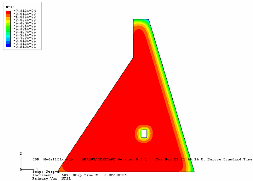
Figur 5.19 Temperaturfördelning vid extrema vinterförhållanden.
