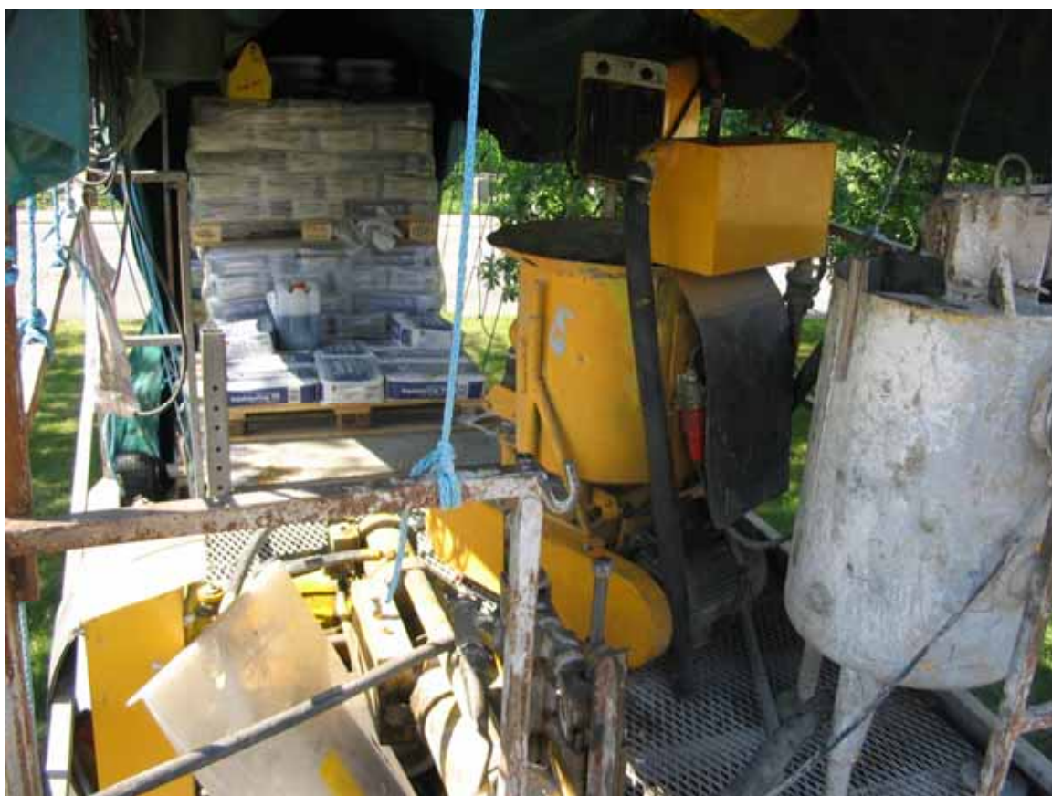
Figur 5.6 Craeliusblandaren i mitten och omröraren till höger i bild
