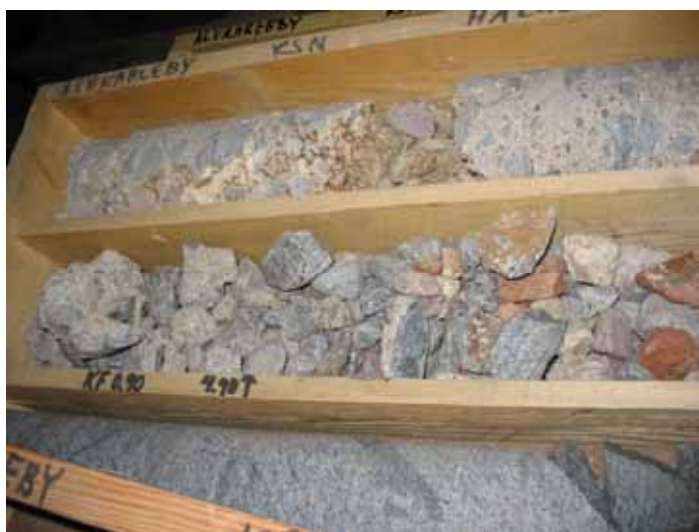
Figur 9.1 Dålig borrhärna från kärnkartering
