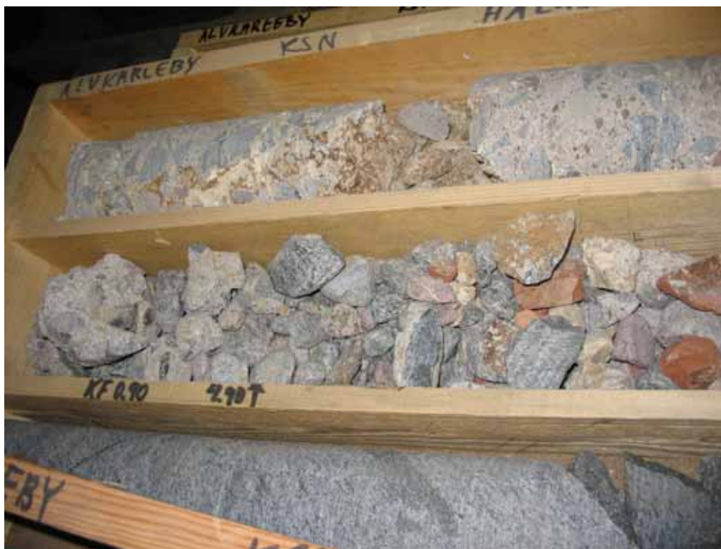
Figur 4.1 Exempel på betong av klass 6
