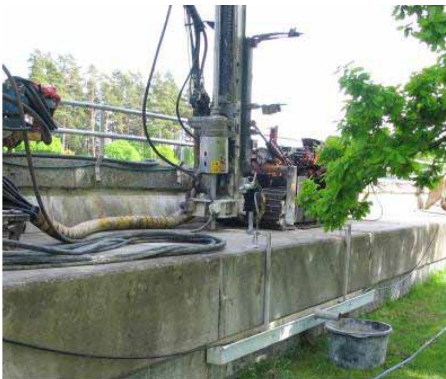
Figur 5.2 Borrutrustning som används är en Onram 1000/3 från Hagby
