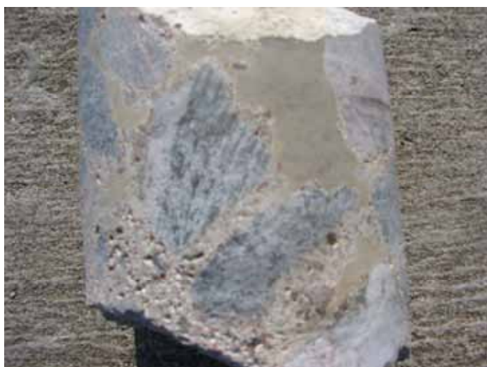
Figur 9.2 Borrkärna med inträngt injekteringsbruk
