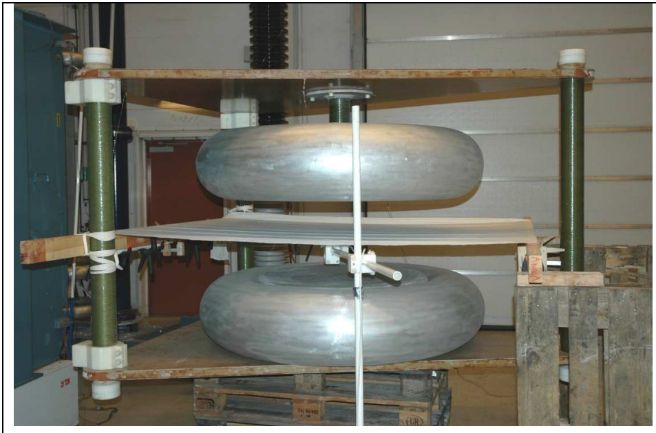
Figur 26. Provuppställning för uppmätning av skärmförmåga.
