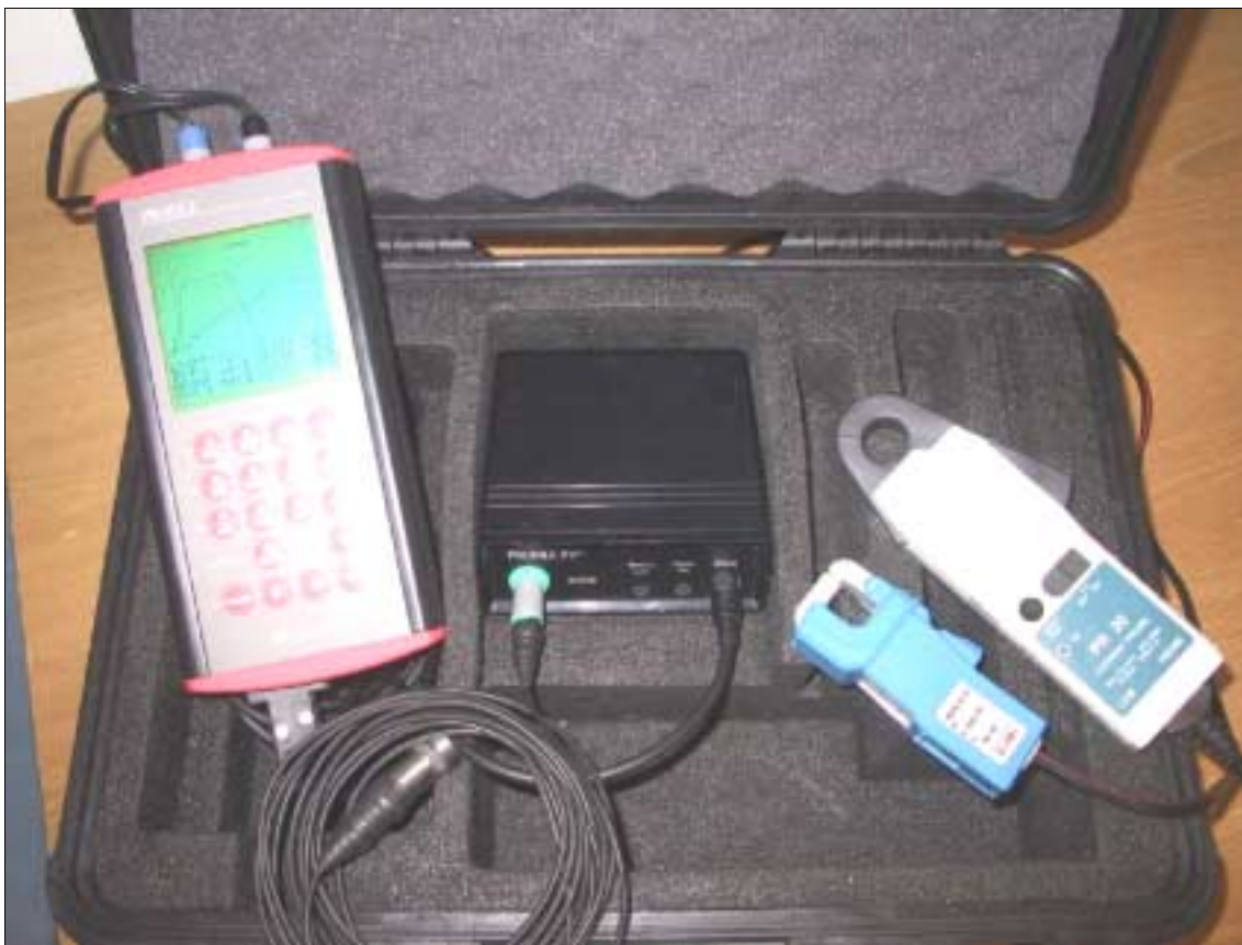
Figur 4.2 - Kelmans Profile P1+ utrustning, som är handhållen, ryms komplett i en väska. Från vänster: Profile P1+, anpassningsmodul för accelerometer, strömtänger för mätning av till- och frånslagstider och spolströmmar. Nedtill syns accelerometern för mätning av vibrationer. I utrustningen ingår även en streckkodsläsare.
