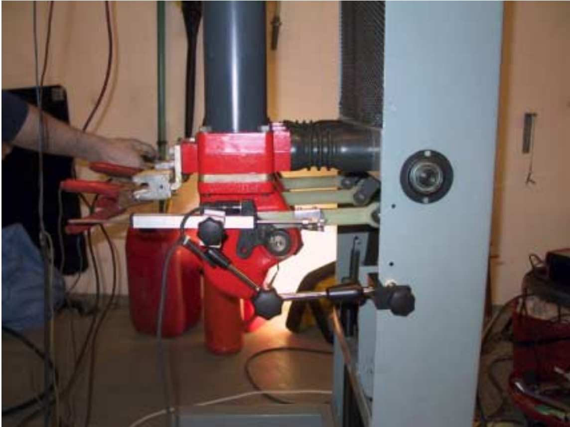
Figur 5.26 – Placering av linjärgivare för uppmätning av rörelsekurva med Programma TM1600. ASEA HKK 12/1225 KM (Torsvik, Birka Nät).
