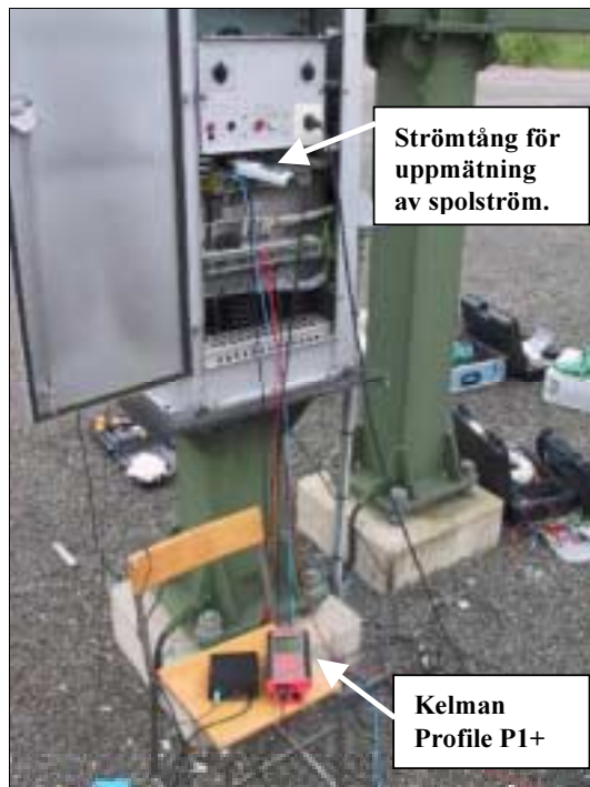
Figur 4.4 - Inkoppling av Kelmans mätutrustning för funktionskontroll på en Asea HLR 400 kV brytare. Strömtången var placerad vid tillslags- och fränslagsmagnetens återledare. Accelerometern var placerad vid pilen. Bild: Vattenfall Utveckling AB.
