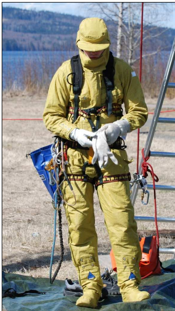
Figur 48. Montör från ELTEL Networks i ledande dräkt inköpt från franska EDF Serect. Dräkten är en hel overall med hög krage. Den kompletteras utanpå skorna med överdragssockor, som knäpps ihop med byxbenen. Handskarna är dubbla och knäpps likaså ihop med overallen. På bilden bär montören en huva, likaså förbunden med overallen. Dräkten kan dessutom kompletteras med ett ledande visir för bästa skyddsverkan.
