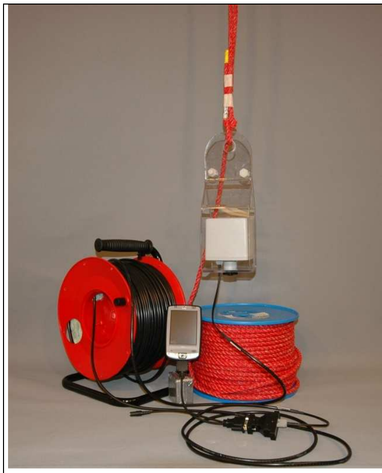
Figur 41. Mätsystem för mätning av B- och E-fält nära spänningssatta föremål. På bilden är mätinstrumentet monterat i en hållare av Lexan som hänger i ett isolerande rep. Till vänster står en trumma med optisk fiber och i mitten syns den lilla handdatorn för avläsning av mätdata.
