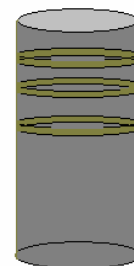
Figur 3-4 Den slutliga lösningen med strängar av Marin-tekniksilikon.
