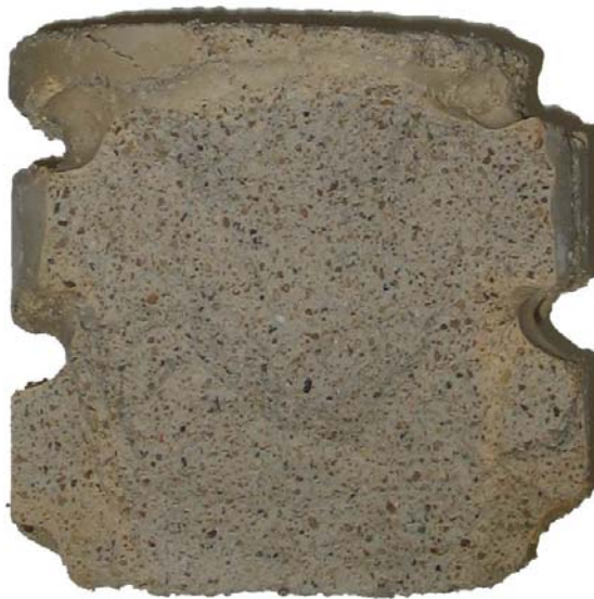
Figur 4-5 Här visas den övre delen av en itusågad provkropp. Det går att se en tydlig gulaktig nyansskiftning längs med kanterna, vilket kan tyda på att det passerade vattnet strömmat just i dessa partier.
