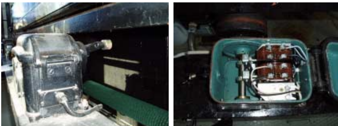
Figur 3.10 Gränslägesbrytare där manöverarm med rulle påverkar kontaktfunktionen.
