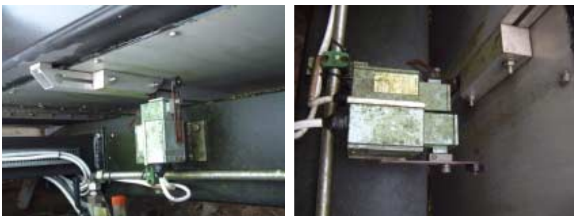
Figur 3.9 Justerbar infästning av påverkansdon.
