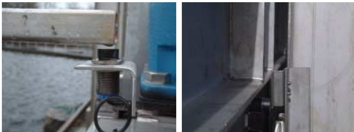
Figur 3.13 Induktiva givare och påverkansdon med öppen respektive mer skyddad placering.
