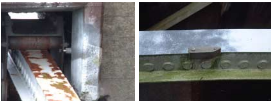
Figur 3.5 Gränsläge som påverkas av kuggstångens rörelse.
