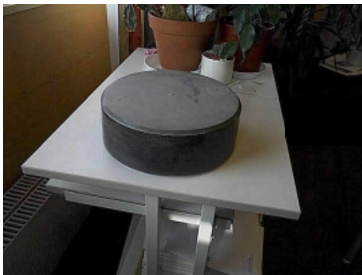
Figur 4-3 Block av bentonitpulver pressat under 100 MPa tryck [45].
