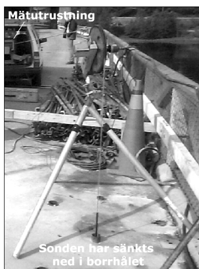
Figur 4.5 Fotografi från mätningar vid Forshuvud i juni 1999. Stativet styr sondens väg så att den ligger väl centrerad i borrhålet.
