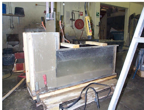
Bild 11.2. Självkompakteradebetong med något styvare konsistens, utbredning av sättmått 570 mm.
