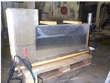
Bild 11.1. Undervattensbetong med AUV-medel.
