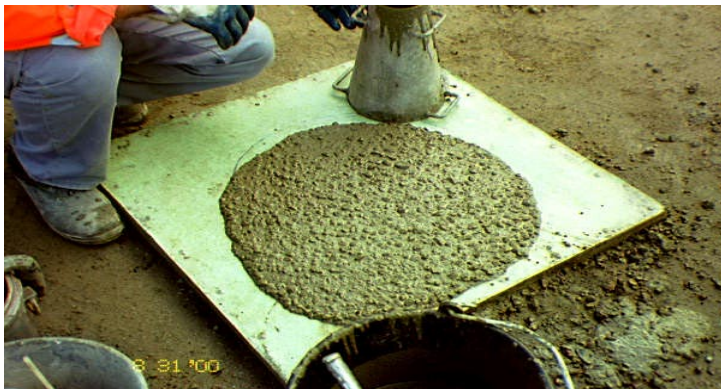
Figur 8.5. Sättnått på undervattensbetong.
