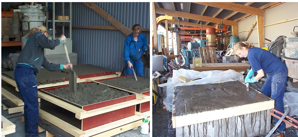
Figur 5.1 och 5.2. Gjutning av referensblock respektive applicering av lagningsbruk.
