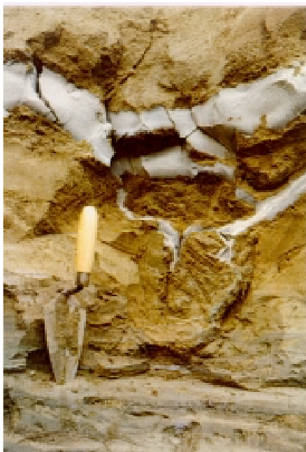
Figur 3. Bild visande uns av cement-bentonitbruk i finsand. Gdynia Dry Dock, Polen, 1976
