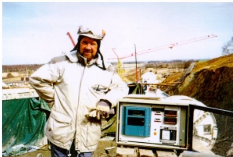
Figur 4. Utrustning för registrering av tryck och flöde, använd vid fältförsöken vid Hallandsås. Med på bilden är författaren i fältmundering
