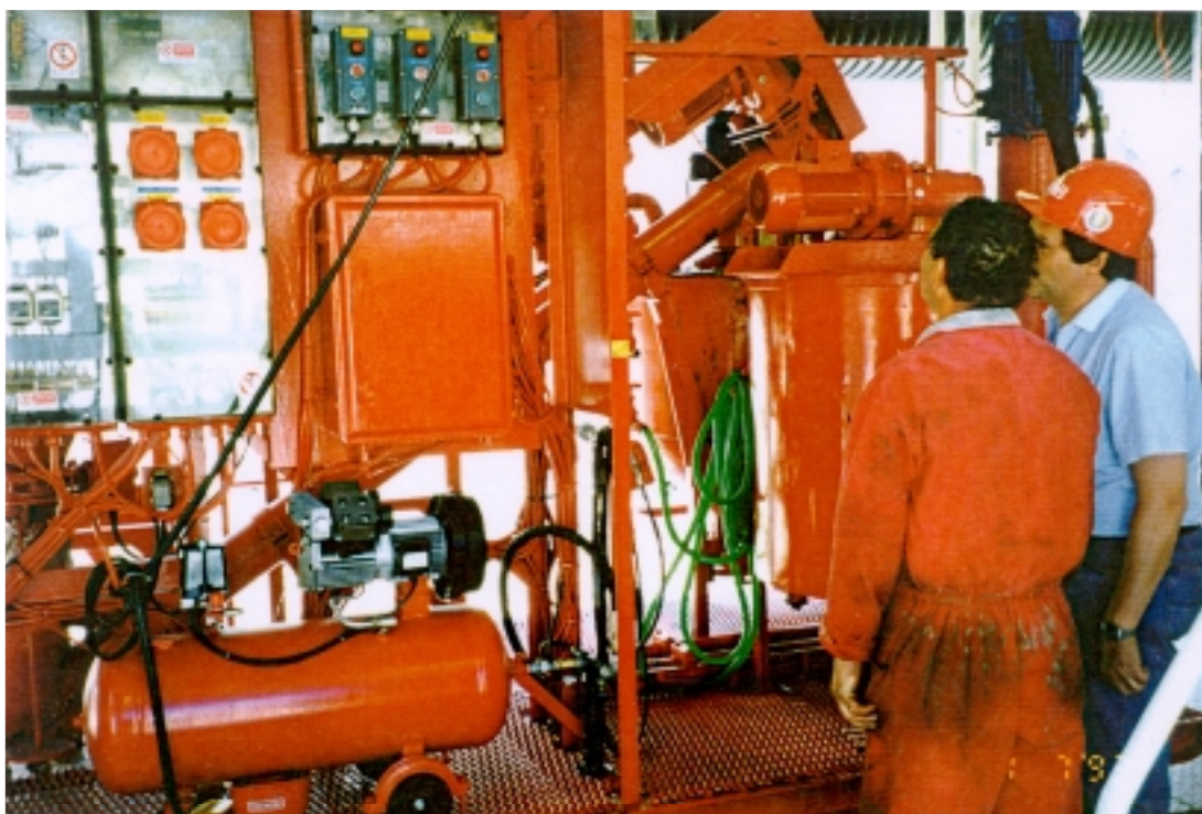
Figur 5. Del av modern injektionsstation med automatisk blandning. Levererad av Rodio till Hallandsås 1993.
