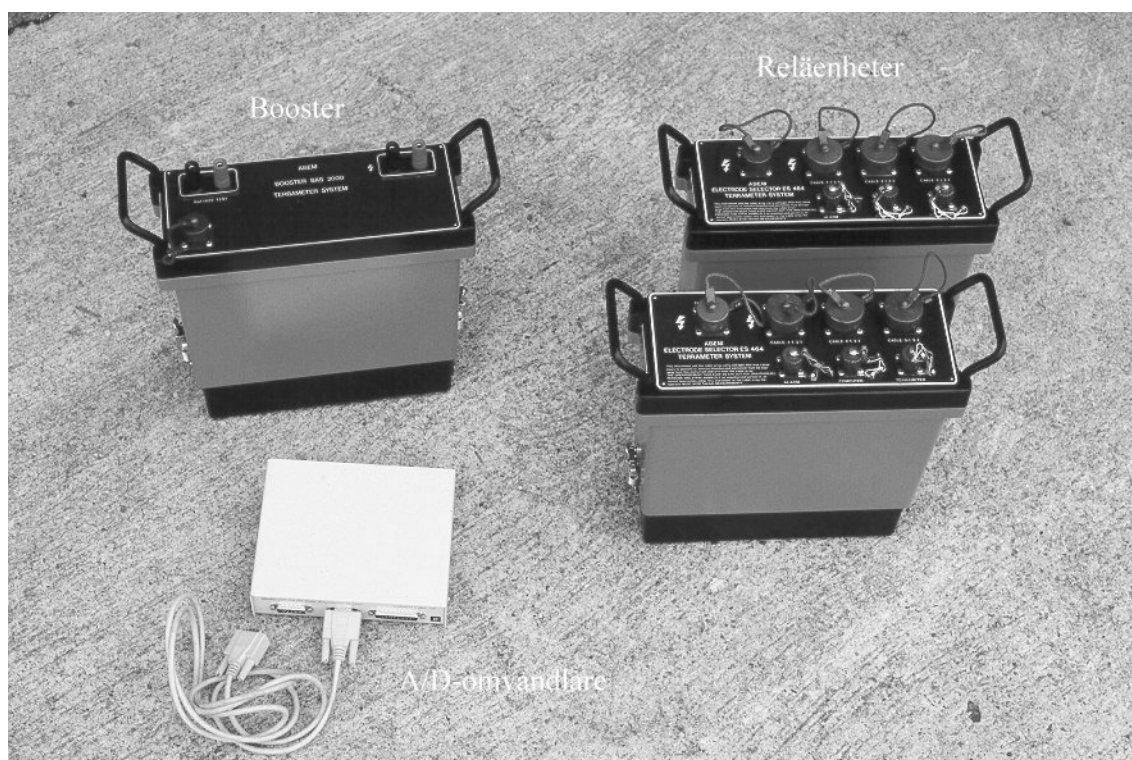
Figur 44. Omkopplingsenheter, strömsändare och A/D-omvandlare/voltmeter.
