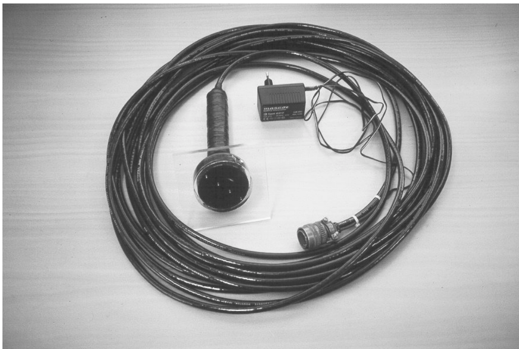
Figur 53. Undervattensprob för mätning av magasinsvattnets temperatur och resistivitet. Probens överdel byggdes efter att fotot togs in i en cylinder fylld med ballast för stabilisering under vatten.
